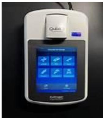
Figura 14: Sistema de cuantificación flurimétrica Qubit®
