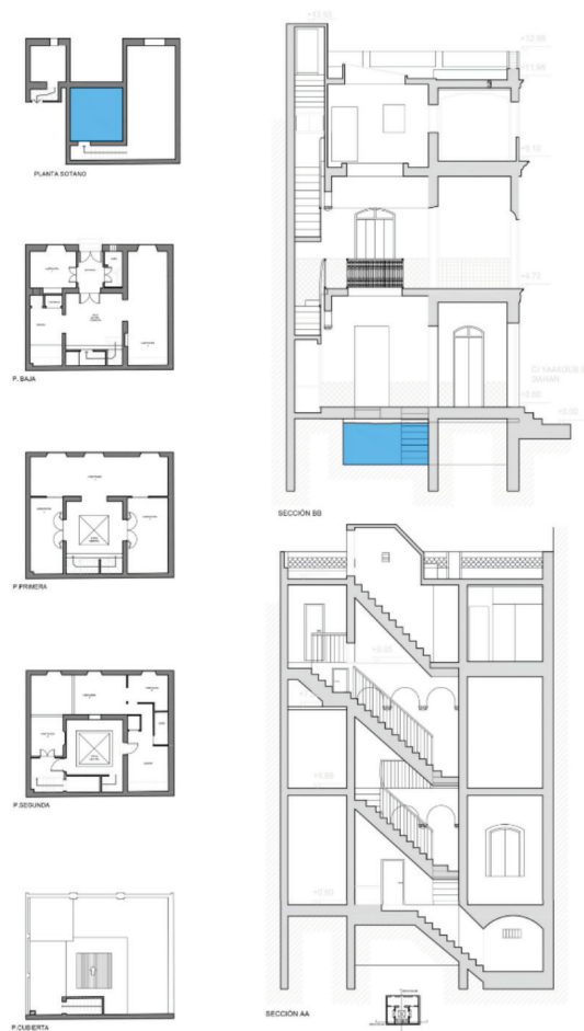
Figura 10. Situación del aljibe en Casa Bakali ( Derb Yaacoub Ben Dahan n.º 7) en el barrio Mellah al-Jadid . Arriba plantas, derecha sección
