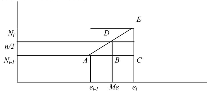
Entonces, por semejanza de triángulos tenemos que  $AC/AB = CE/BD$ , que es equivalente a:
