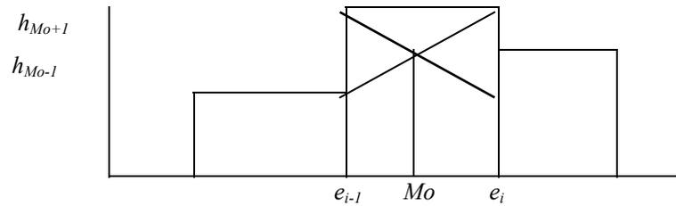
Entonces, por proporcionalidad de bases y alturas de los triángulos creados,  $B/(B+b) = H/(H+h)$ , que en nuestro caso es equivalente a:
