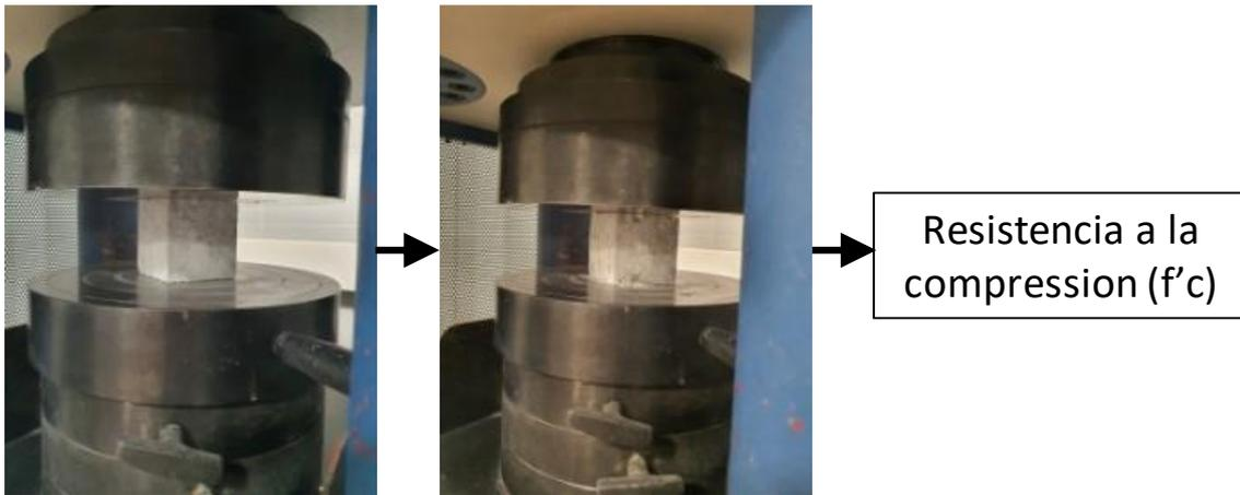
Figura 4.3.6. Ensayo de resistencia a la compresión.
