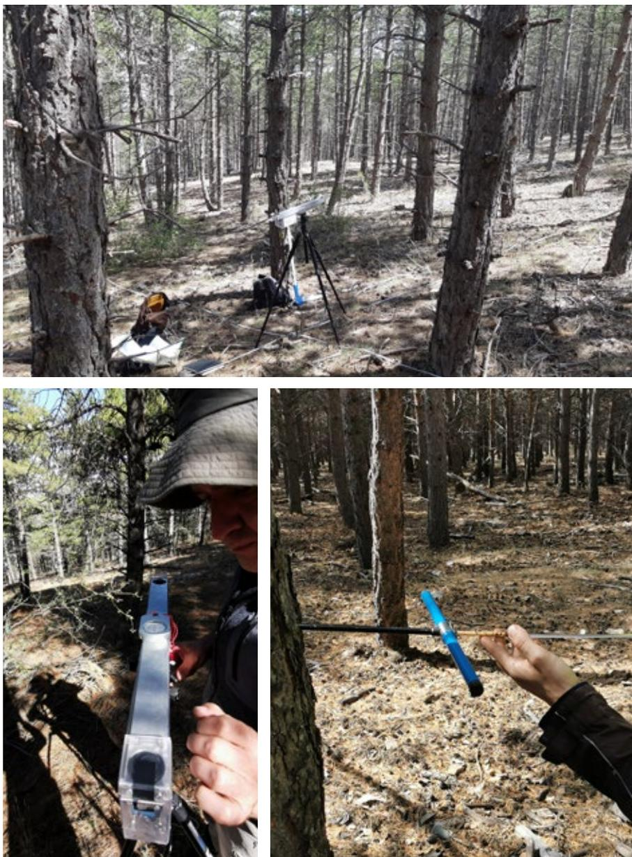
Foto 10. Seguimiento de campo en el P. N. Sierra Nevada, incluyendo muestreo de dendrocronología con barrena de Pressler y toma de fotografías hemisféricas estereoscópicas con dispositivo Foresterio.
