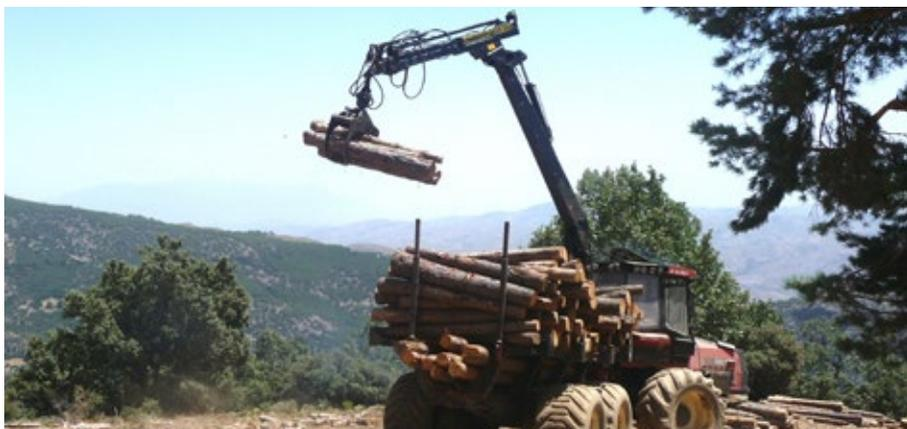
Foto 11. Una vez apeados y desramados, el autocargador transporta los troncos hasta un lugar accesible al camión que los llevará al aserradero o a la planta de biomasa, dependiendo de la calidad de la madera.
