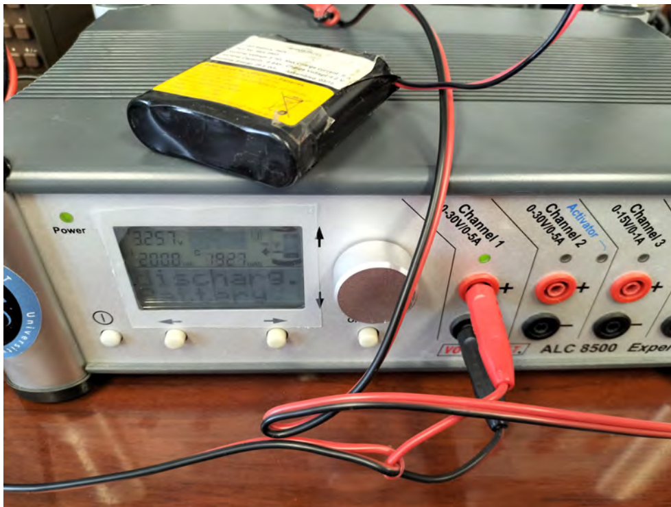
Figura 4.74 – Conexión de la batería al ALC-8500
