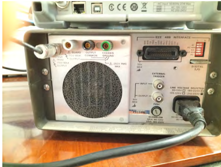
Figura 3.20 – Interfaz GPIB (IEEE 488) de la fuente de corriente
