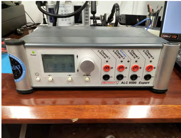
Figura 4.69 – Cargador de baterías ALC-8500
