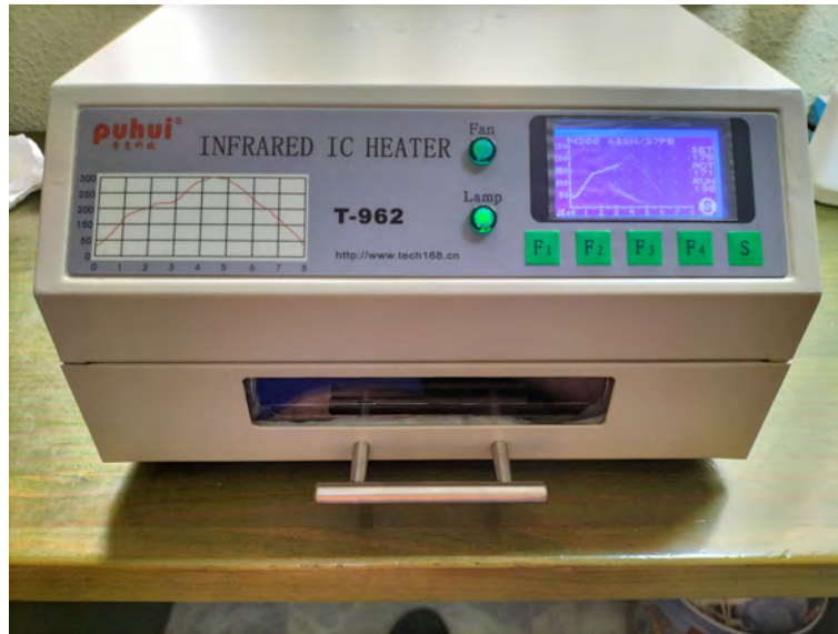
Figura 4.51 – Proceso de soldadura en horno infrarrojo
