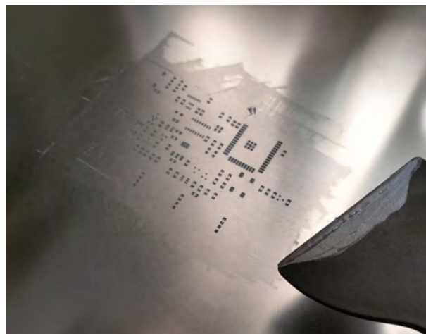
Figura 4.46 – Aplicación de la pasta de soldadura
