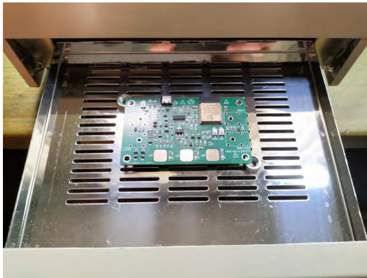
Figura 4.50 – Componentes colocados antes de soldar
