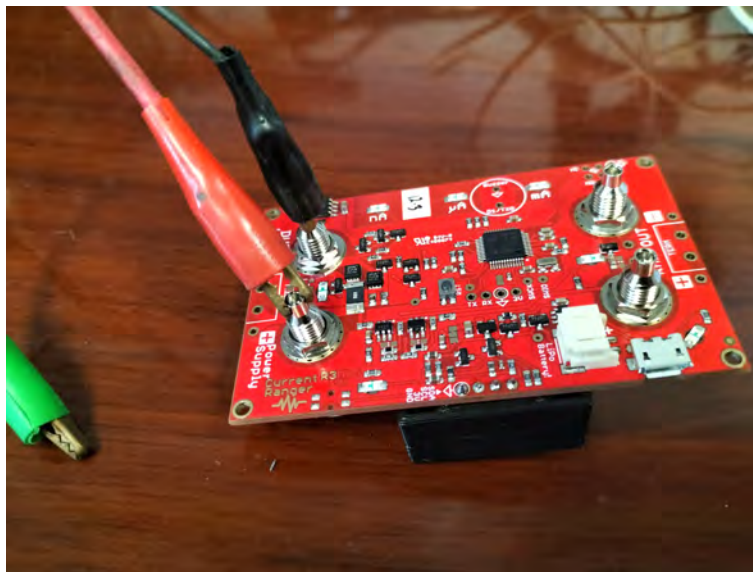
Figura 3.18 – Conexión de la fuente de corriente al CurrentRanger
