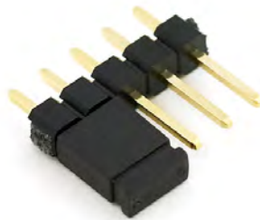
Figura 4.82 – Puente para pines
