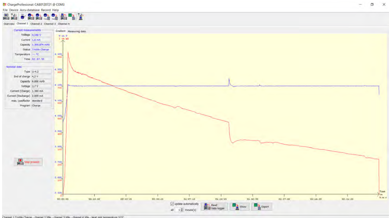
Figura 4.77 – Final de la carga de la batería
