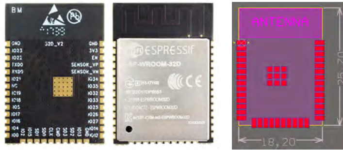
(a) Modelo real (b) Huella Figura 4.2 – Microcontrolador ESP32-WROOM-32E
