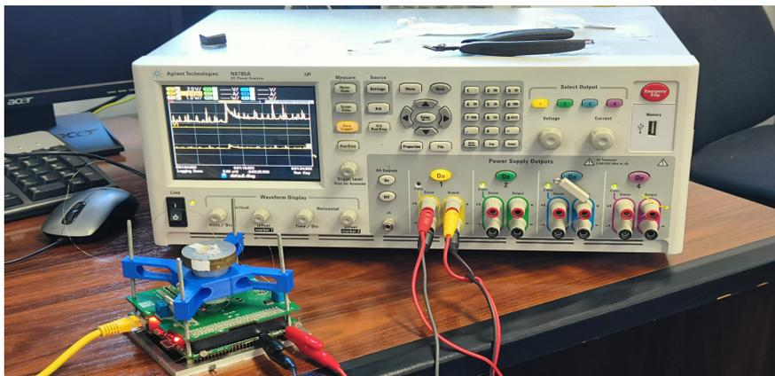
**Figura 7.7** – *Medida de la potencia con Power Analyzer*
