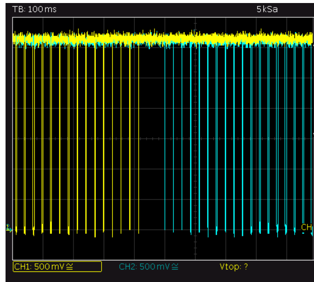
Figura 3.29 – Señales de control en las puertas de los transistores Q8 y Q9
