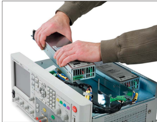
Figura E.4 – Módulos de Power Analyzer N6705A. [16]
