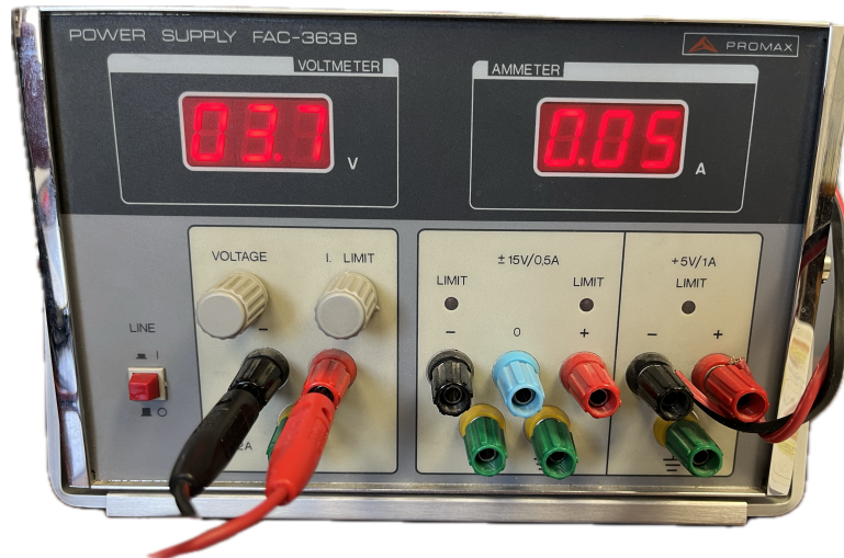
Figura E.8 – Fuente de tensión FAC 363 B de los laboratorios de GranaSAT
