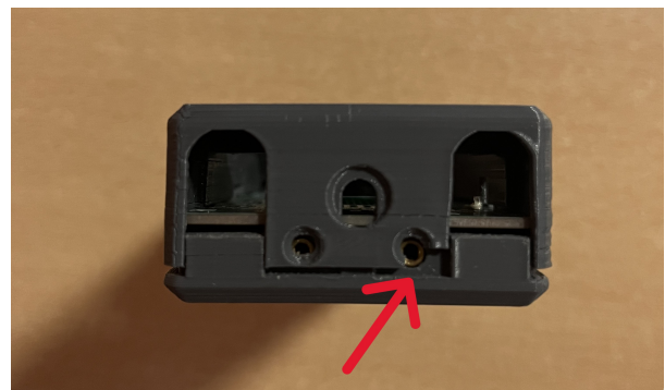
(b) Orificio para la ubicación de tornillo de sujeción.
