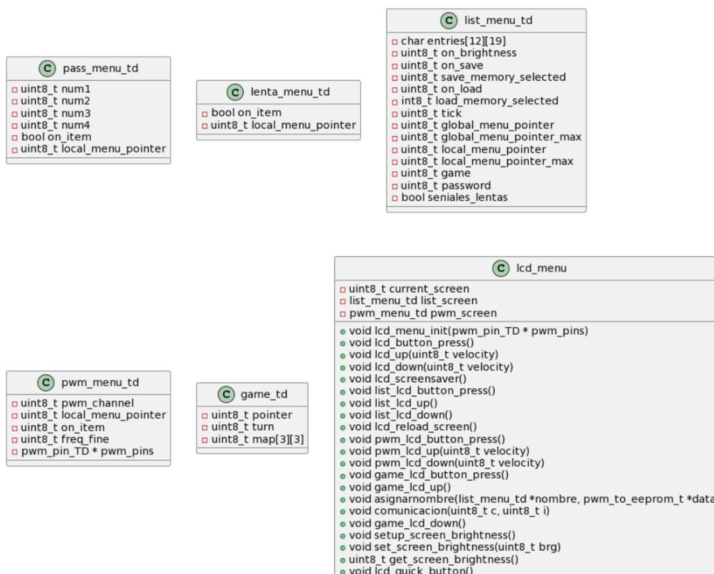
Figura 23: Diagrama de clases del display.
