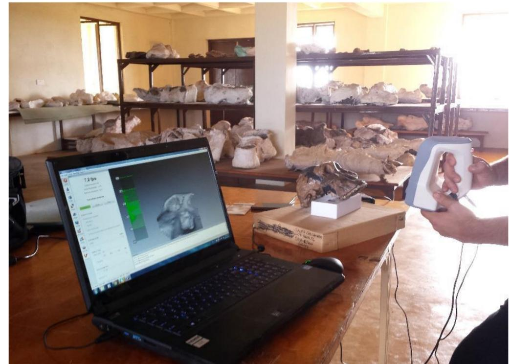
Artec Space Spider, escáner de alta resolución 3D de luz azul
