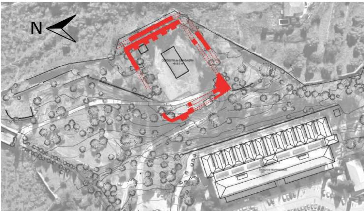
**Fig. 10.** Propuesta provisional de la planta del edificio nazarí identificado en el entorno del Albergón sobre el plano previo a la intervención de 2021-2022. En línea discontinua los muros que se presuponen, pero no se han identificado. En rojo las estructuras documentadas.
