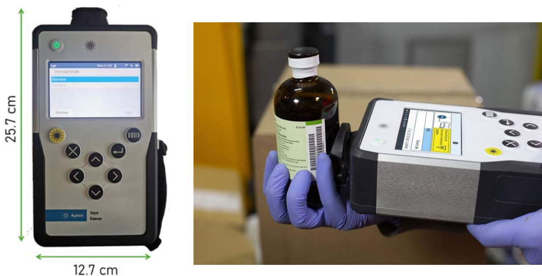
Figura 5.1. Espectrómetro portátil basado en la técnica SORS que ha sido empleado en los estudios presentados en forma de publicaciones científicas en el Capítulo 2 .
