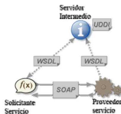
Figura 66. Diagrama de flujo de datos en un servicio Web
