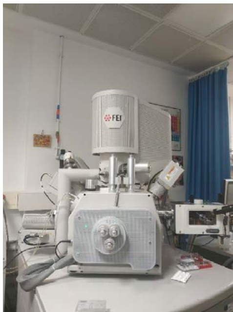
Figura 2.5.4: Equipo Auriga (FIBFESEM).
