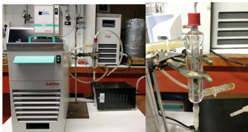
Figura 2.6.1: montaje experimental de columna de lecho fijo y detalle de la columna
