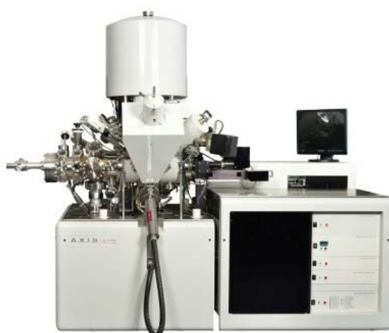
Figura 2.5.7: Equipo Axis Ultra-DLD (Fuente: catalogo Kratos).
