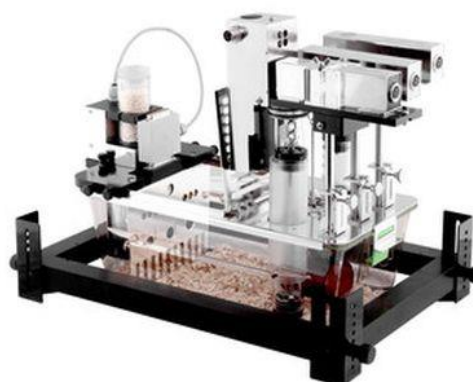
Figura 7. Equipo de calorimetría indirecta. Imagen obtenida de [1].
