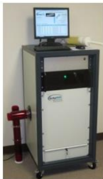
Figura 5. Equipo de resonancia magnética nuclear. Imagen obtenida de la web de EchoMRI [3].
