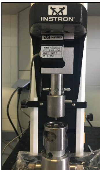
Figura 7. Ensayo de flexión en tres puntos. Instron 3345 disponible en el laboratorio de Investigación de la Facultad de Odontología de la Universidad de Granada.
