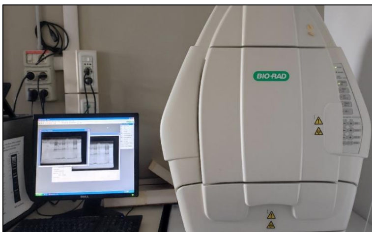
Figura 14. Electroforesis con gel y escáner de luz ultravioleta de onda larga Chemi-Doc Universal Hood disponible en la Universidad de Bologna.
