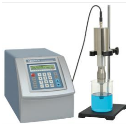
Figura IV.6 – Sonda de ultrasonidos empleada para la formación de la emulsión con las nanopartículas de sílice Aerosil® A200
