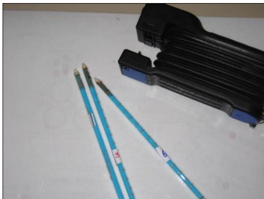
Figura 52: Tubos colorimétricos y bomba de aspiración (Fuente: elaboración propia).
