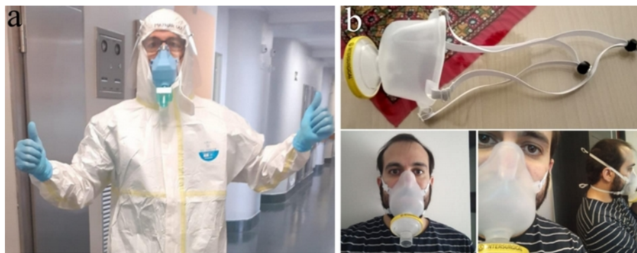
Figura 3. (a) Segundo prototipo de LibreMask siendo probado por personal sanitario. (b) Máscaras enviadas a AITEX con arneses para la cabeza y filtros de respirador, para ser homologadas.
