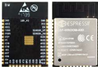
(d) Espressif ESP32-WROOM-32D. Extracted from: [94].
