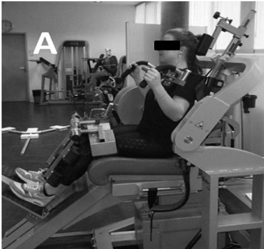
Figura 15. Evaluación de los flexores del tronco a través de un dispositivo isocinético. Imagen extraída del artículo de Roth et al. (2017)
