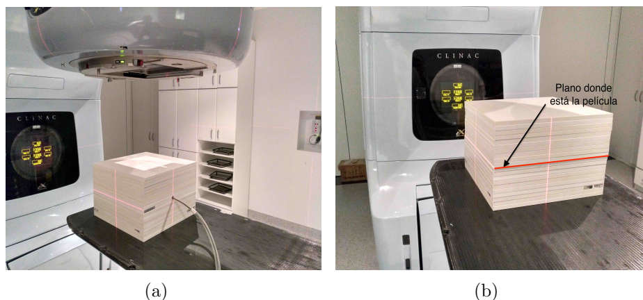
Figura 2.19: a) Medida de dosis con cámara en el mismo plano donde se irradia la película b) Película en maniquí de láminas de plástico
