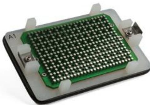
Figura 30. Estación de lavado empleada en la técnica Multiplex con esferas magnéticas. Fuente: Bio-Rad
