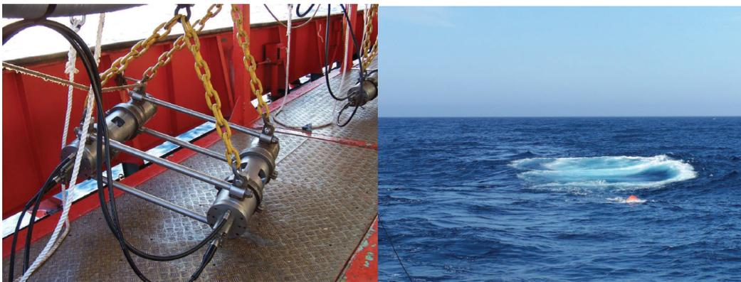
Figura 5.2: Izquierda: configuración de los cañones de aire comprimido. Derecha: burbuja en el mar formada por el disparo de los cañones de aire comprimido.
