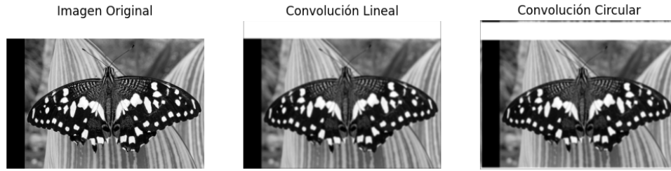
Figura 11.9.: De izquierda a derecha se presenta: la imagen original, la convolución lineal, y la convolución circular sobre esta.
