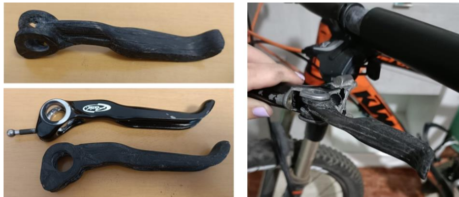
Figura 2. Maneta de freno de bicicleta de montaña fabricada con matriz epoxi-fibra de carbono [3].
