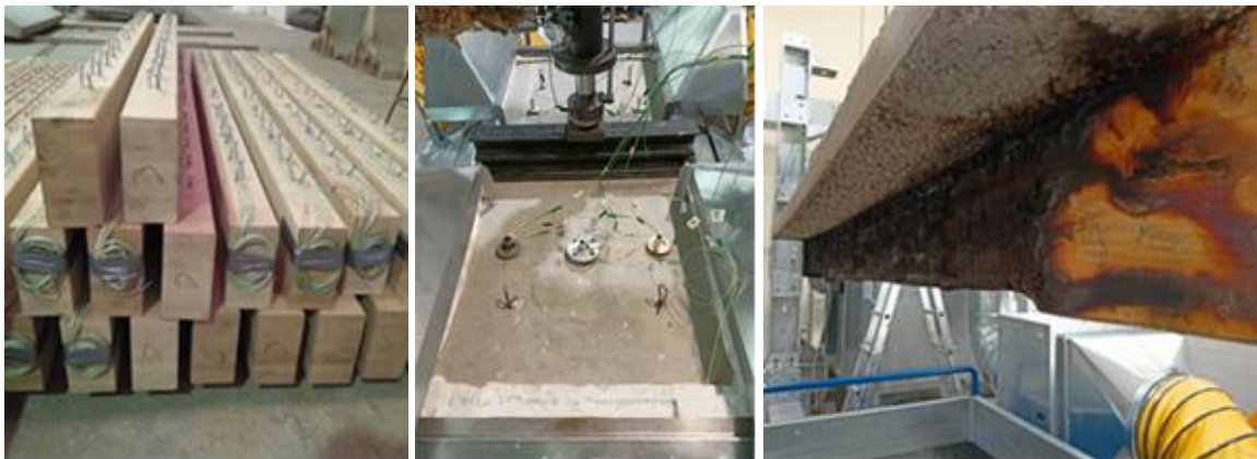
Figura 1. Colocación de los conectores y sensorización mediante termopares de las vigas de glulam (izquierda), vista del montaje de probeta en horno de resistencia al fuego (centro) y sección carbonizada de las vigas de glulam después del ensayo de resistencia al fuego (derecha).
