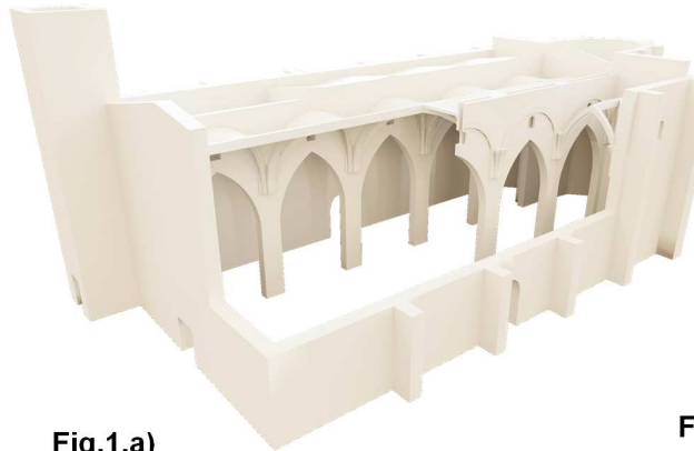
Figure 1. a) Santa Ana. Representación del modelo geométrico con las simplificaciones adoptadas. b). Modelo elaborado con la consideración del edificio en su totalidad (derecha).
