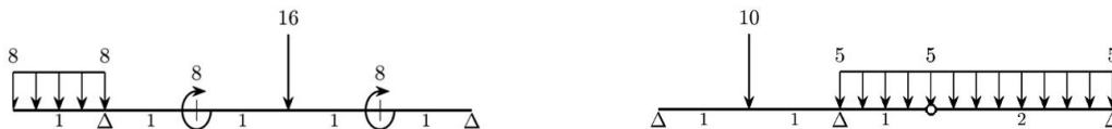
Figura 1. Vigas correspondientes a los problemas propuestos. Las cargas están dadas en kN y las longitudes en m
