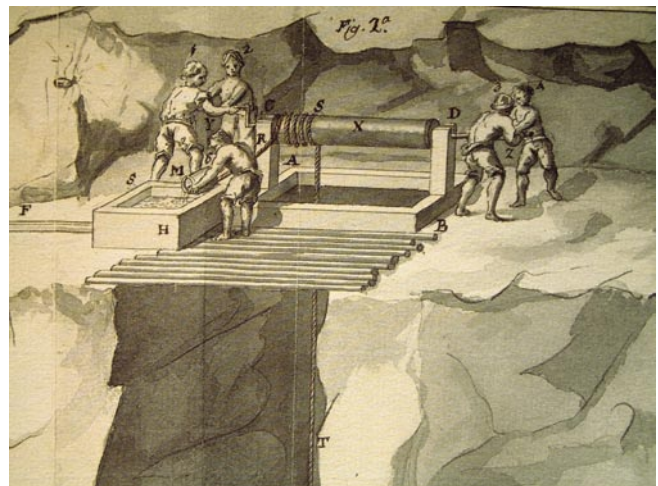
FIG. 2. Esquema de accionamiento de un torno.
