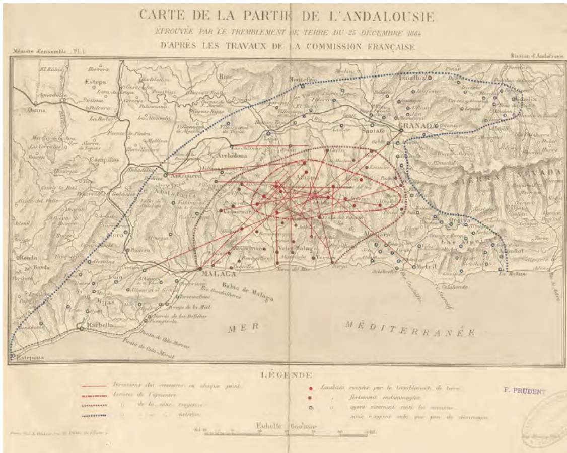
Carte de la Partie de l'Andalousie, éprouvée par le tremblement de terre du 25 décembre 1884. D'après les travaux de la Comission Française. Escala del original 1/600000. Aparecen representadas las curvas que marcan los límites de la zona externa, media y epicentral, así como las direcciones de las sacudidas en ciertos puntos; dibujadas estas últimas apoyándose en las informaciones recopiladas por las tres Comisiones.
