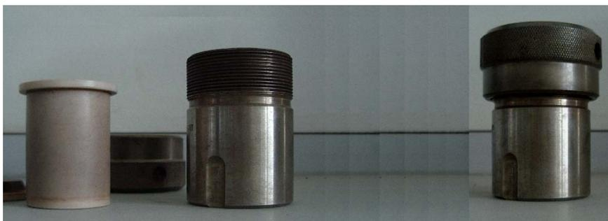
Figura 1.16. Autoclaves utilizadas en síntesis hidrotermal.
