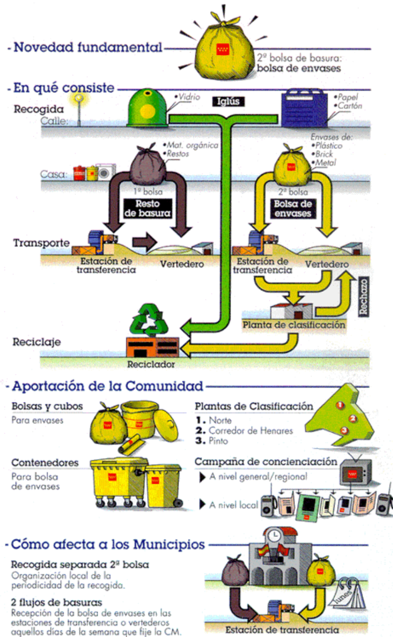
Figura 1.- Esquema de aplicación del Plan Autonómico de Gestión de los Residuos Urbanos de la Comunidad de Madrid
