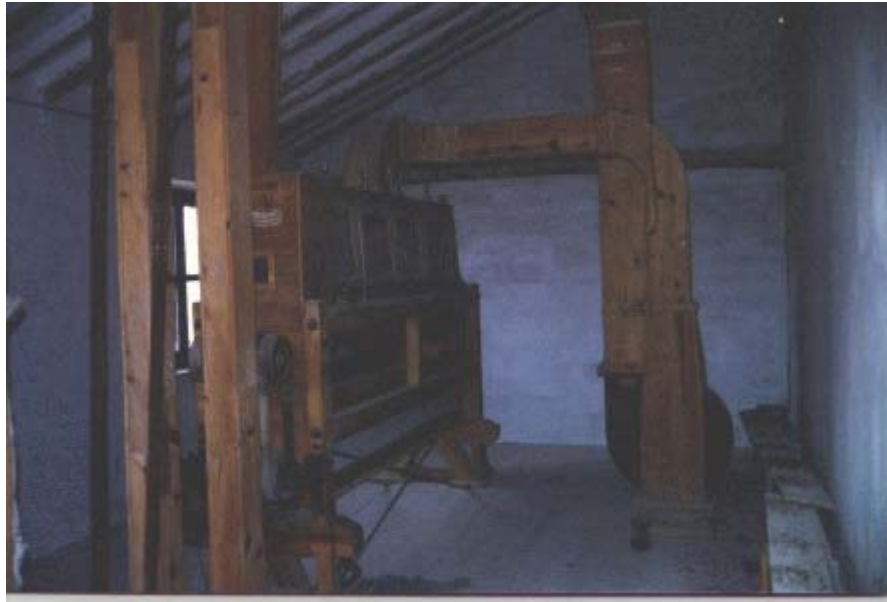
Torno cernedor. Molino del Batán. Caniles (Granada).
