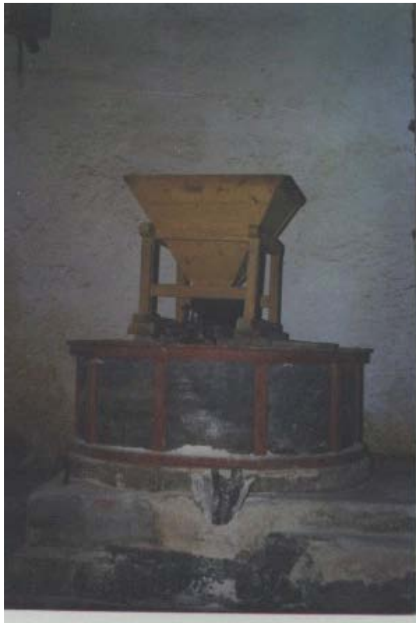
Molino, guardapolvos y tolva. Molino de la Torre. Alomartes (Granada).
