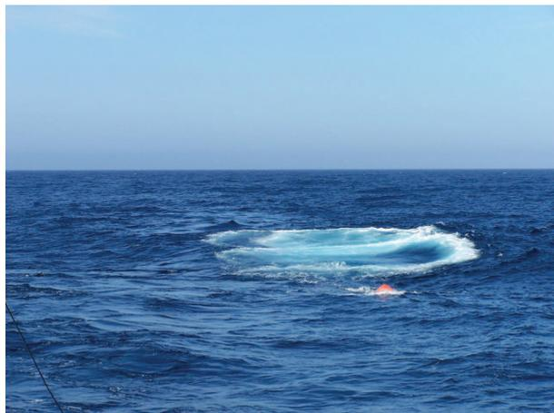
**Figura 4.11:** *Burbuja en el mar formada por el disparo de los cañones de aire comprimido.*
