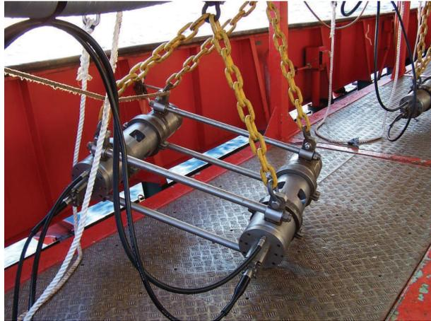
**Figura 4.10:** *Configuración de los cañones de aire comprimido.*
