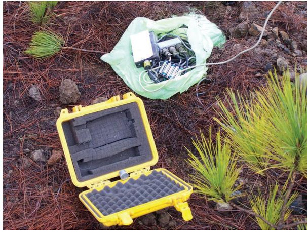
**Figura 4.19:** *Elementos de una estación sísmica, incluidas las baterías usadas para su funcionamiento.*
