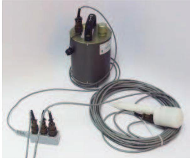
**Figura 4.13:** Estación sísmica correspondiente al modelo Guralp CMG-6TD
