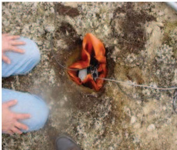
**Figura 4.16:** *Ejemplo de cómo quedaba una estación, una vez dentro de la bolsa y del agujero.*
