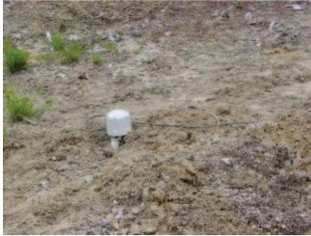
**Figura 4.18:** *Antena GPS, tras tapar la estación sísmica.*
