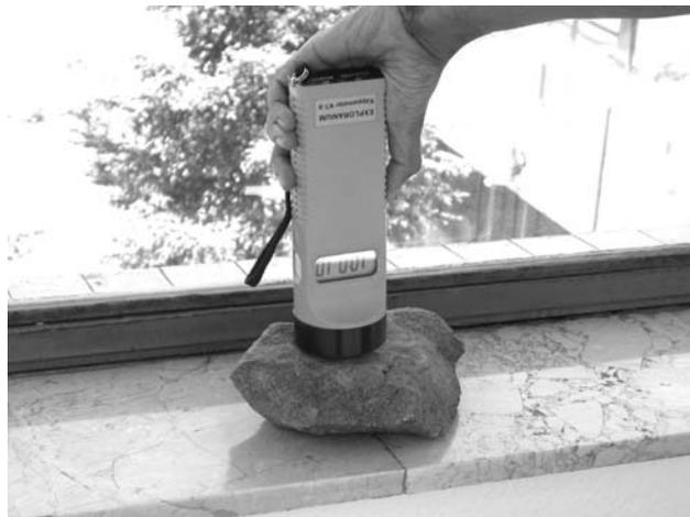
Figura 3.18. Medidor de la susceptibilidad magnética en muestras de campo
