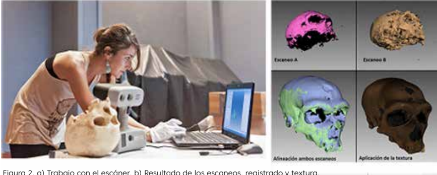
Figura 2. a) Trabajo con el escáner, b) Resultado de los escaneos, registrado y textura.
