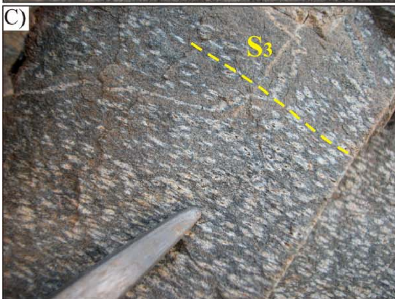
Fig. 7.2. Aspecto macroscópico de una muestra pulida del esquisto verde que contiene los agregados de fibrolita según un plano perpendicular al de la foliación (Unidad de la Punta de la Mona).
