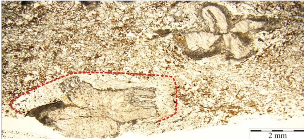
Fig. 6.1. Aspecto general de los quiastolitos de andalucita de los esquistos grafitosos, suprayacentes al ortogneis de Torrox. El cristal de la parte inferior presenta borde moscovítico mientras que el de la parte superior no.
