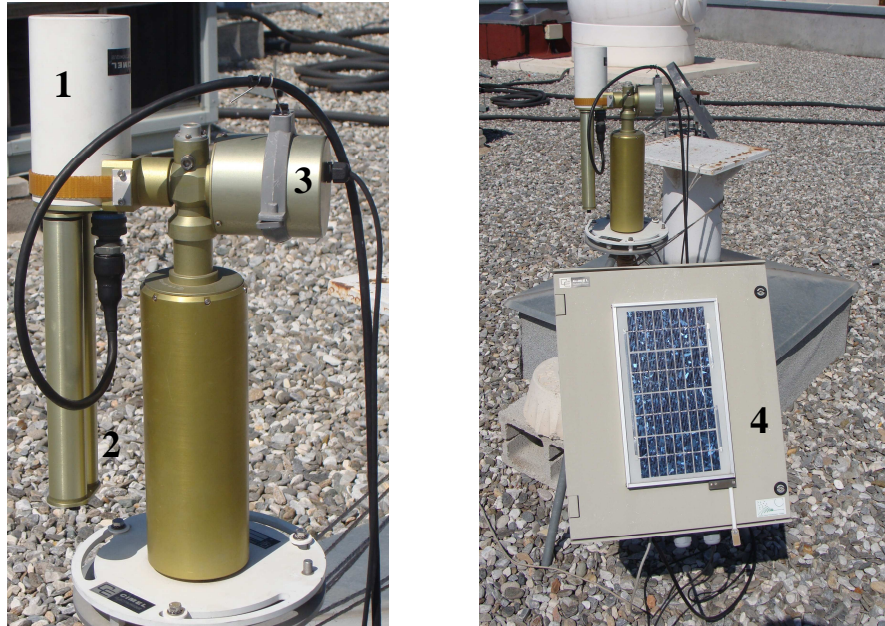
Figura 3.2: Fotómetro solar CIMEL CE-318. (1) Cabeza sensora para apuntar el instrumento y donde se encuentra toda la óptica y todos los detectores necesarios para realizar la medida. (2) Doble colimador. (3) Robot. (4) Caja de control (en el exterior están las placas solares y en el interior se encuentra la caja electrónica de control y las baterías).
