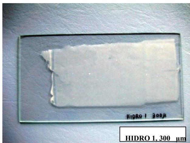
**Fotografía 4.** Fotografía de una extensión de 300 µm de la fórmula *hidrogel 1* con vitamina E (2%) sobre placa de vidrio.
