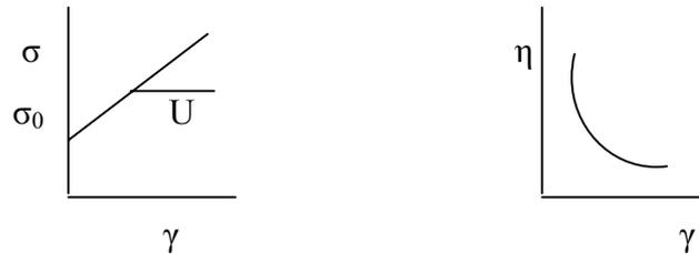
*Reograma de plástico ideal:* Se observa la disminución de viscosidad con el aumento de la velocidad de deformación.
