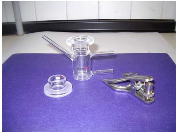
**Fotografía 6.** Celda de Franz de vidrio con doble cámara de cristal para la recirculación de agua atemperada en un baño (17 ml aprox de capacidad). Se empleó en el ensayo de cesión.
