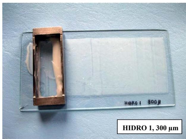
**Fotografía 3.** Fotografía de una extensión de 300 µm de la fórmula *hidrogel 1* con vitamina E (2%) –incorporada en PEG (400:1500, a/a al 5%) sobre placa de vidrio. Se muestra el extensiómetro en el extremo de la placa.
