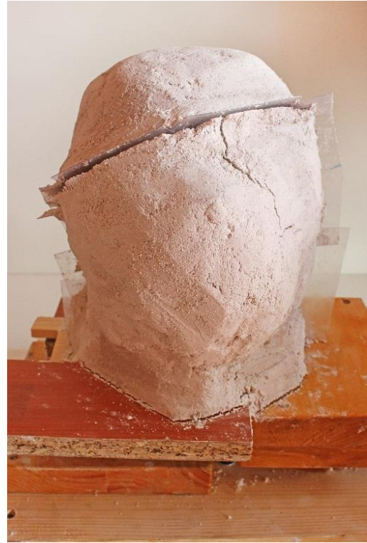
Figura 70: José Javier Ángeles Alejo. (2017) Estudio de la materia: Fases de moldeo con árido algínico . Fotografía digital. Inicio de apertura de las divisiones del molde por retracción de la materia producida por la pérdida de agua y el proceso de fraguado.
