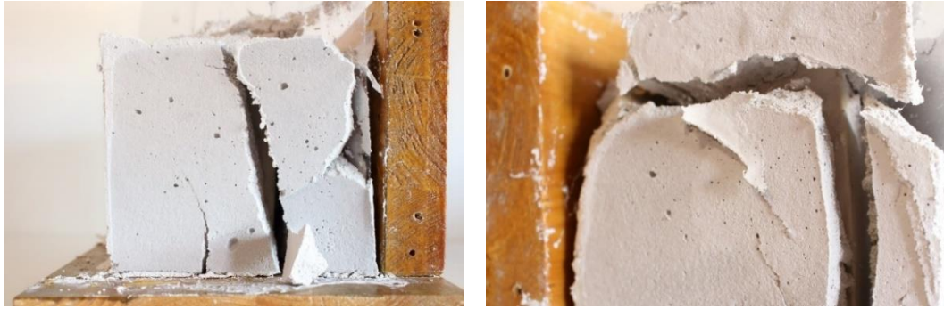
Figura 21: José Javier Ángeles Alejo. (2017) Estudio de la materia: Fases de moldeo con árido algínico . Fotografía digital. Comprobación del resultado. Medición de las fisuras de la superficie.
