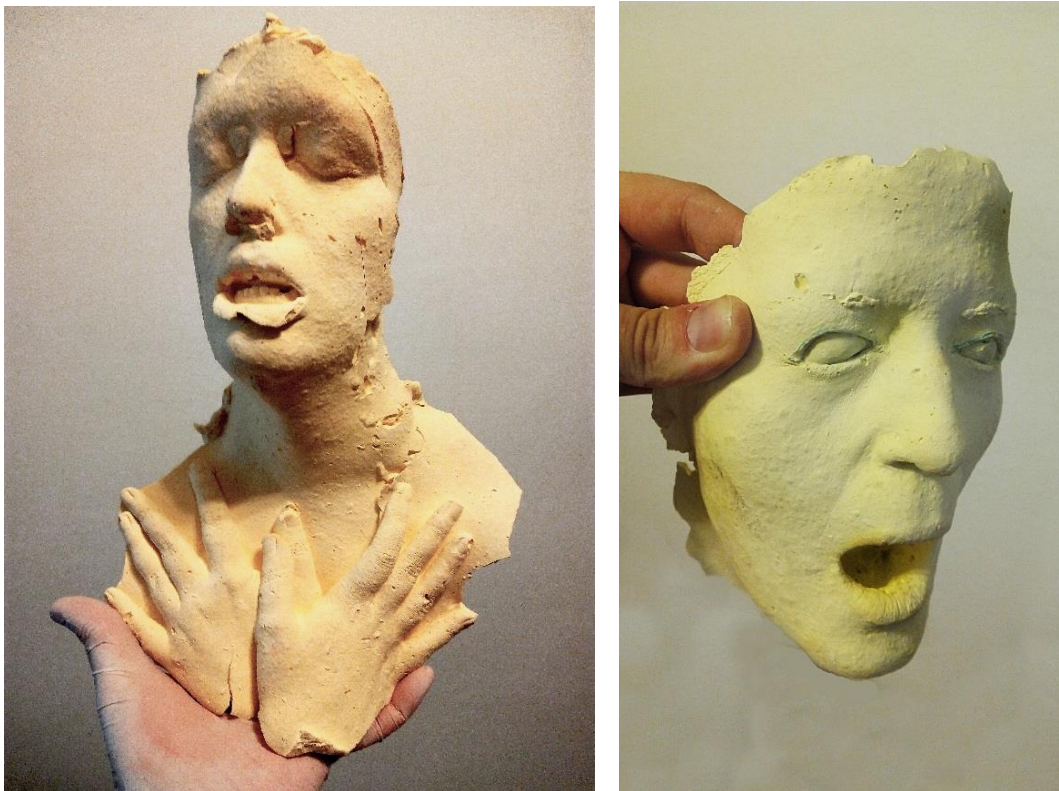
Figura 54: José Javier Ángeles Alejo. (2015) Uso del alginato como materia de reproducción. Fotografía digital. Experimentación basada en cambios dimensionales. Variedad de alginato dental Orthoprint de Zhermack. Izquierda: deformación producida por aumento de temperatura durante el proceso de sinéresis. Derecha: cambio dimensional homogéneo.
