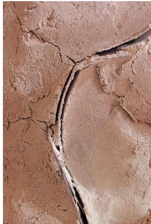
Figura 71: José Javier Ángeles Alejo. (2017) Estudio de la materia: Fases de moldeo con árido algínico . Fotografía digital. Inicio de apertura de las divisiones y agrietado del molde por retracción de la materia.
