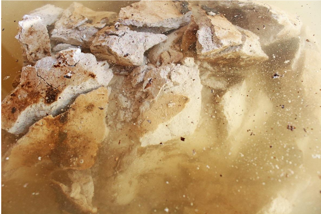
Figura 89: José Javier Ángeles Alejo. (2017) Estudio de la materia: Fases de moldeo con árido algínico . Fotografía digital. Disgregación gradual de los fragmentos de mayor tamaño. Vista de la reproducción de escayola del interior del molde.
