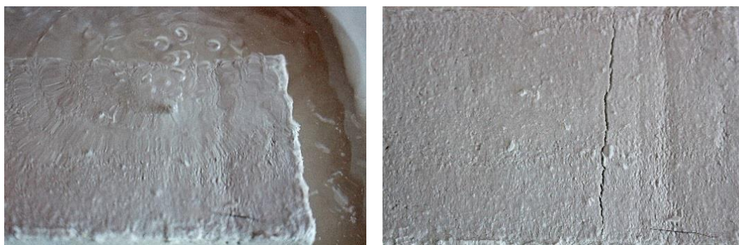
Figura 51: José Javier Ángeles Alejo. (2017) Probeta n°5 . Fotografía digital. Absorción de agua. Inicio de aparición de grietas en la superficie.
