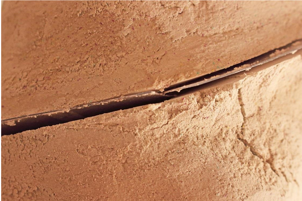
Figura 72: José Javier Ángeles Alejo. (2017) Estudio de la materia: Fases de moldeo con árido algínico . Fotografía digital. Inicio de apertura de las divisiones del molde por retracción de la materia producida por la pérdida de agua y el proceso de fraguado.
