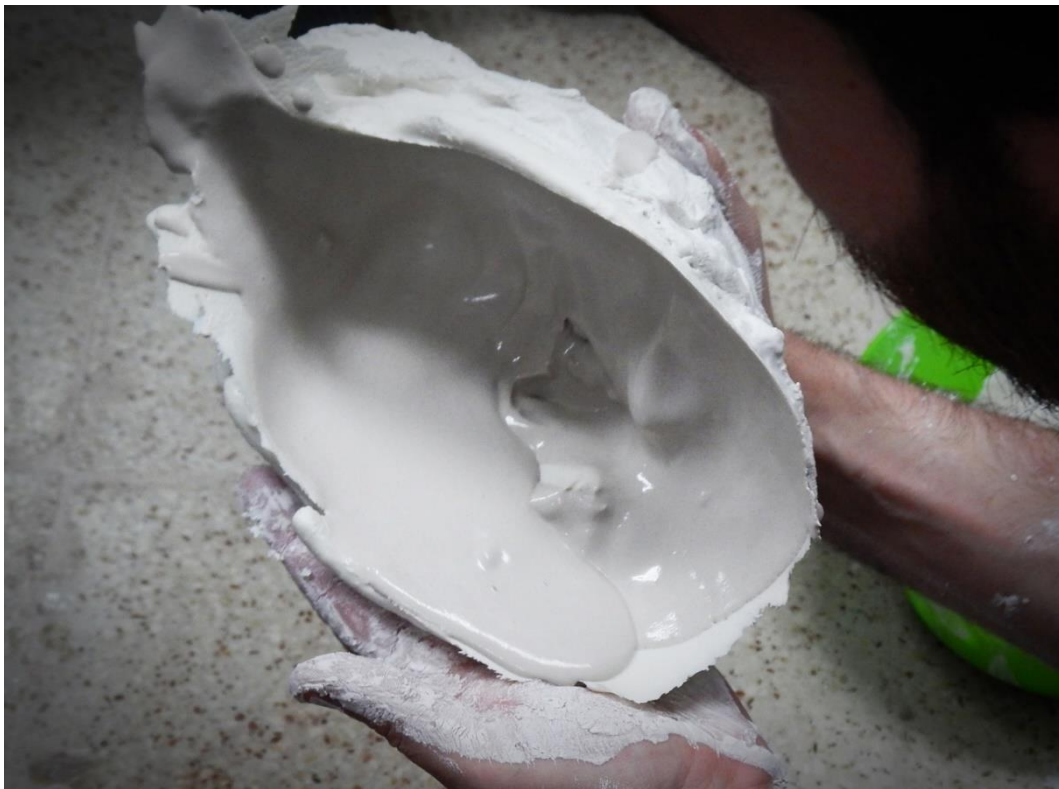
Figura 134: Fotografía de Francisco Milla Gómez. (2015) Fases de moldeo con alginato dental llevadas a cabo por los alumnos de la Escuela de Arte Gaspar Becerra de Baeza. Fotografía digital. Vertido de escayola en el interior del molde.
