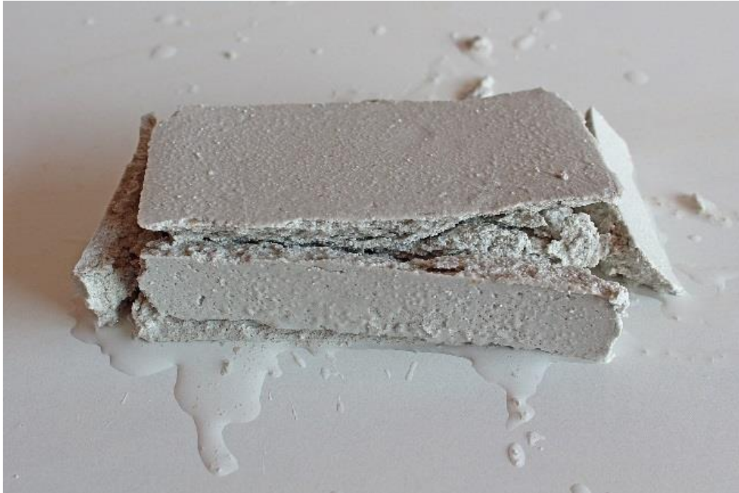
Figura 59: José Javier Ángeles Alejo. (2017) Probeta n°6 . Fotografía digital. Deformación total de la superficie por absorción masiva de agua.
