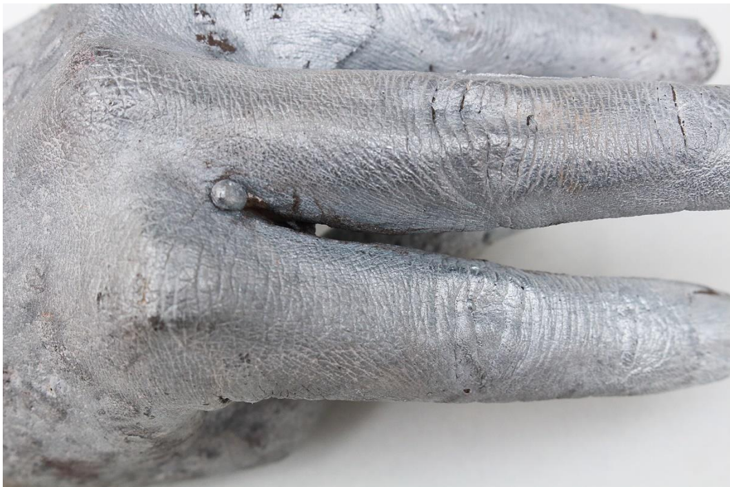
Figura 131: José Javier Ángeles Alejo. (2018) Mano reproducida en zamak. Fotografía digital. Detalle de reproducción de burbuja generada durante el proceso de moldeo con alginato dental.
