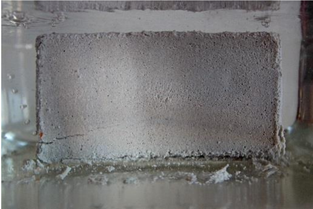
Figura 19: José Javier Ángeles Alejo. (2017) Probeta n°1 . Fotografía digital. Árido algínico reutilizado. Proceso de absorción de agua. Inicio de aparición de pequeñas grietas.
