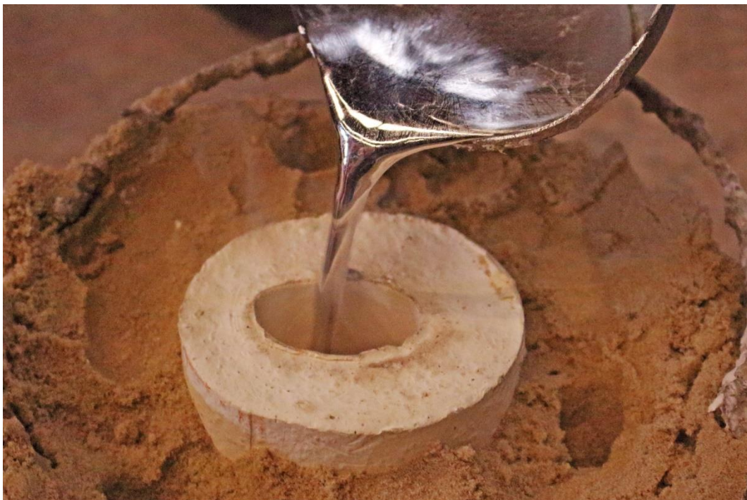
Figura 123: José Javier Ángeles Alejo. (2018) Vertido de zamak en el interior del molde de alginato deshidratado. Fotografía digital.
