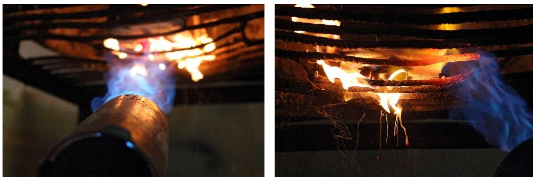
Figura 40: José Javier Ángeles Alejo. (2017) Estudio de la materia: Fases de moldeo con árido algínico . Fotografía digital. Izquierda: aplicación de fuego directo por medio de soplete de butano. Campana de extracción de cera. Derecha: expulsión de cera del interior del molde.
