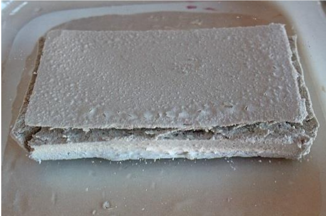
Figura 57: José Javier Ángeles Alejo. (2017) Probeta n°6 . Fotografía digital. Aumento de volumen por absorción masiva de agua.
