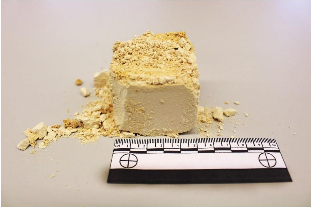
Figura 108: José Javier Ángeles Alejo. (2018) Alginato dental fraguado y deshidratado a 200° C. Fotografía digital. Prueba de ultrasonidos. Extracción de la materia del recipiente tras concluir las mediciones de ultrasonidos.
