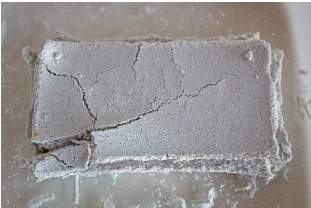
Figura 20: José Javier Ángeles Alejo. (2017) Probeta n°1 . Fotografía digital. Árido algínico reutilizado. Proceso de absorción de agua. Aparición de grietas de mayor tamaño.
