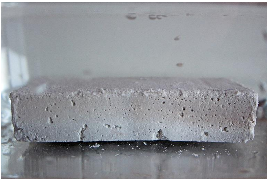
Figura 50: José Javier Ángeles Alejo. (2017) Probeta n°5 . Fotografía digital. Proceso de absorción de agua.
