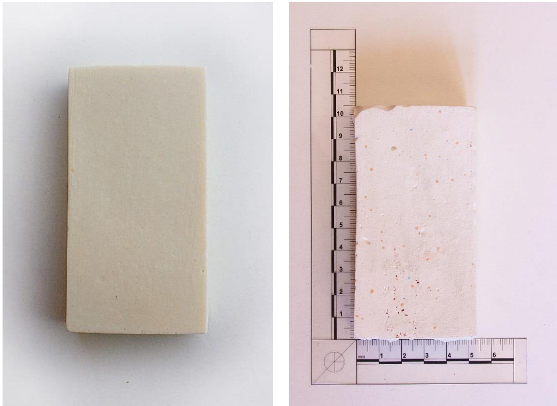
Figura 28: José Javier Ángeles Alejo. (2017) Izquierda: probeta n°4 . Fotografía digital. Alginato fraguado tras el proceso de gelificación. Derecha: probeta n°4 . Retracción de la materia tras el secado.
