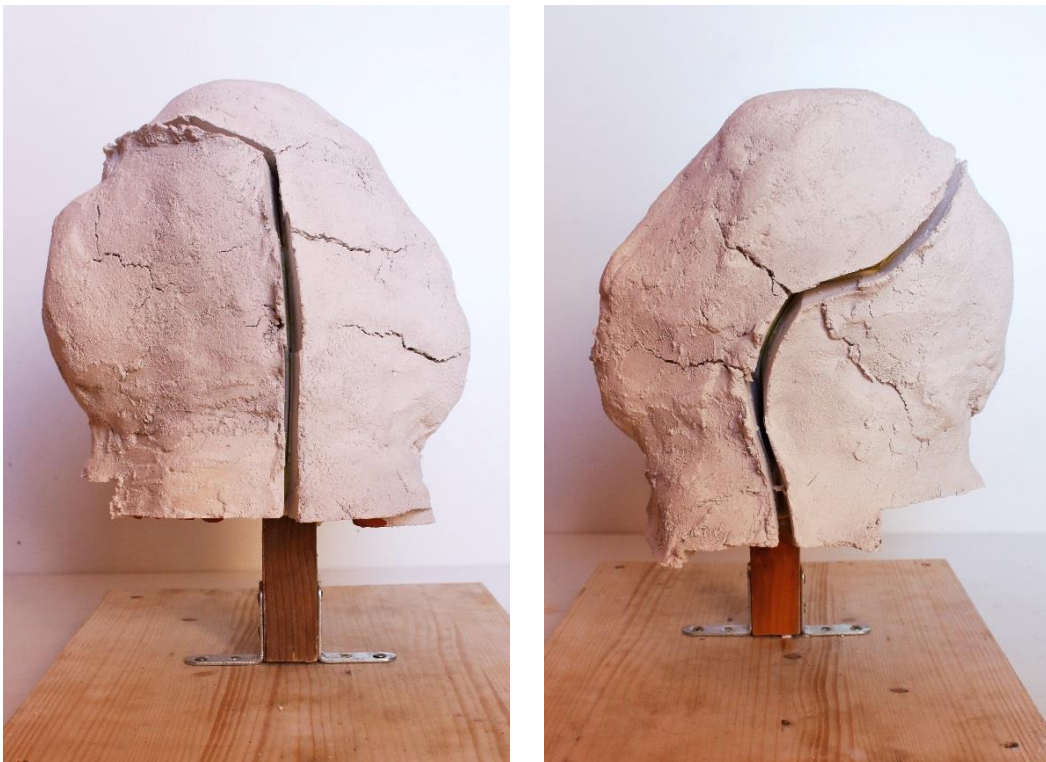
Figura 75: José Javier Ángeles Alejo. (2017) Estudio de la materia: Fases de moldeo con árido algínico . Fotografía digital. Molde en avanzado estado de retracción. Proceso de secado concluido. Vistas laterales.
