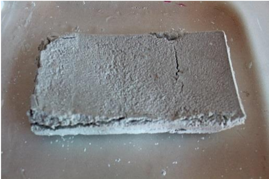
Figura 33: José Javier Ángeles Alejo. (2017) Probeta n°1 . Fotografía digital. Proceso de absorción de agua. Inicio de aparición de pequeñas grietas en las aristas de la probeta.
