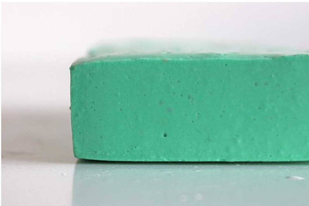
Figura 10: José Javier Ángeles Alejo. (2017) Apreciación de aumento de volumen en la curvatura de los vértices de la pieza. Fotografía digital.
