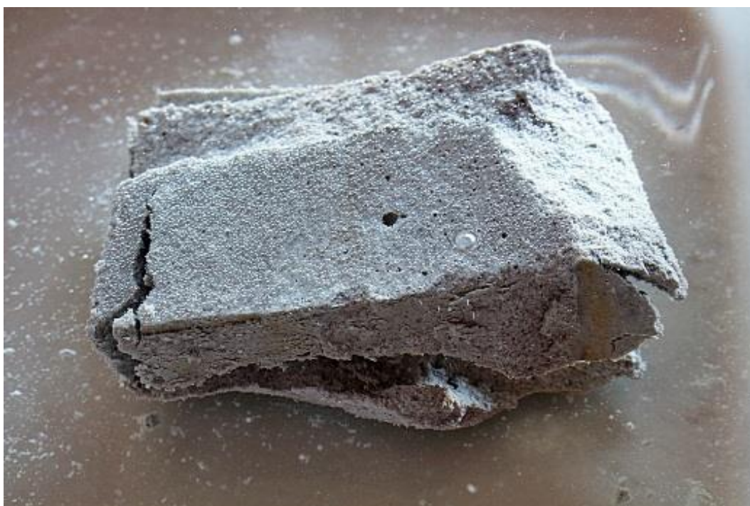
Figura 2: José Javier Ángeles Alejo. (2017) Primera prueba de inmersión . Fotografía digital. Proceso de absorción de agua de fragmento solidificado constituido únicamente por árido algínico. Inicio de agrietamiento de la superficie producido por una absorción masiva de agua.
