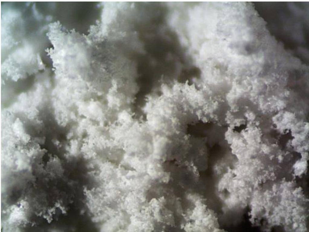
Figura 24: José Javier Ángeles Alejo. (2017) Observación superficial de árido algínico obtenido del alginato dental Phase plus de Zhermack por medio de Microscopio Metalográfico Trinocular AmScope. Fotografía digital.
