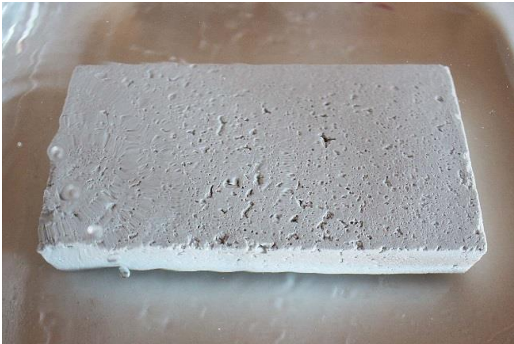
Figura 45: José Javier Ángeles Alejo. (2017) Probeta n°4 . Fotografía digital. Proceso de absorción de agua.
