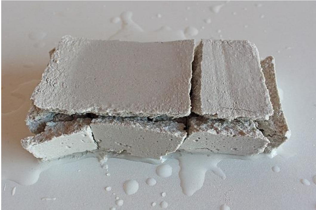
Figura 54: José Javier Ángeles Alejo. (2017) Probeta n°5 . Fotografía digital. Extracción de la probeta del recipiente de observación. Rotura de la pieza en fragmentos regulares.
