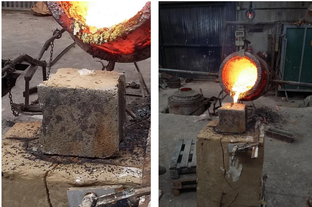
Figura 137: José Javier Ángeles Alejo. (2018) Izquierda: molde de alginato dental seco en el interior del encofrado de hormigón. Derecha: vertido de bronce fundido en el interior del molde de alginato seco. Fotografía digital.
