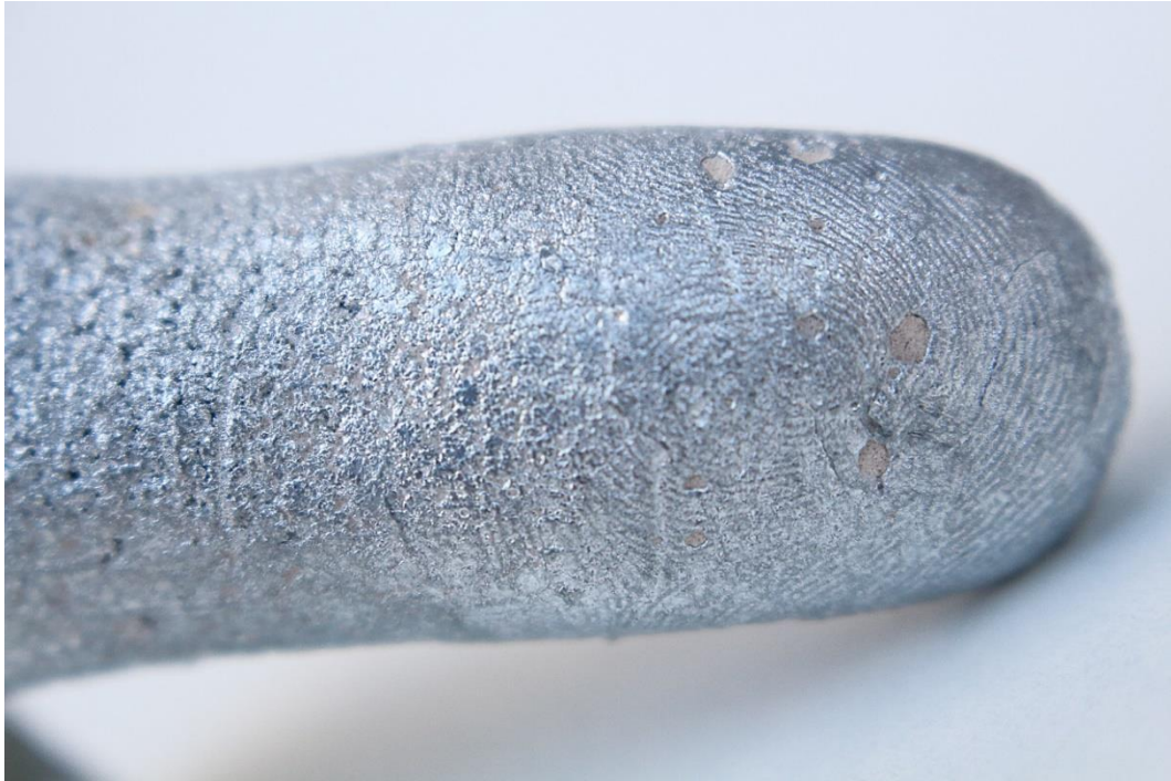
Figura 117: José Javier Ángeles Alejo. (2018) Reproducción en zamak n°2. Fotografía digital. Fragmentos de molde incrustados en la propia reproducción. Detalle.
