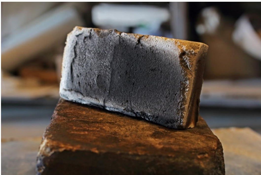
Figura 4: José Javier Ángeles Alejo. (2017) Prueba de combustión y resistencia térmica. Fotografía digital. Enfriamiento de la pieza. 2 horas de la combustión.
