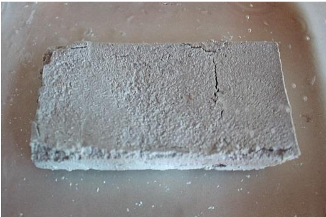
Figura 32: José Javier Ángeles Alejo. (2017) Probeta n°1 . Fotografía digital. Proceso de absorción de agua.
