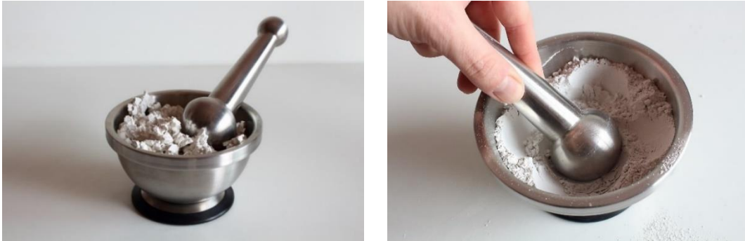
Figura 11: José Javier Ángeles Alejo. (2017) Obtención de árido algínico . Fotografía digital. Izquierda: fase de molienda de los fragmentos de alginato dental seco en mortero metálico. Derecha: micronizado de los fragmentos.
