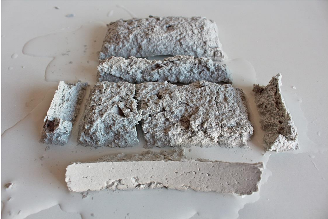
Figura 12: José Javier Ángeles Alejo. (2017) Probeta n°2 . Fotografía digital. Separación manual de fragmentos regulares producidos por absorción de agua.
