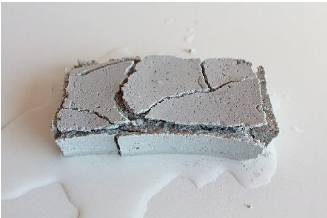
Figura 39: José Javier Ángeles Alejo. (2017) Probeta n°2 . Fotografía digital. Disgregación de la probeta. Rotura por contacto.
