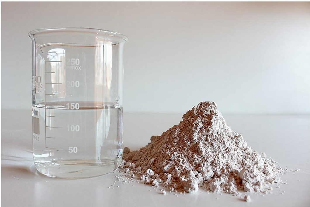
Figura 87: José Javier Ángeles Alejo. (2017) Materia constitutiva de la probeta de escayola E-35 fraguada micronizada. Fotografía digital.
