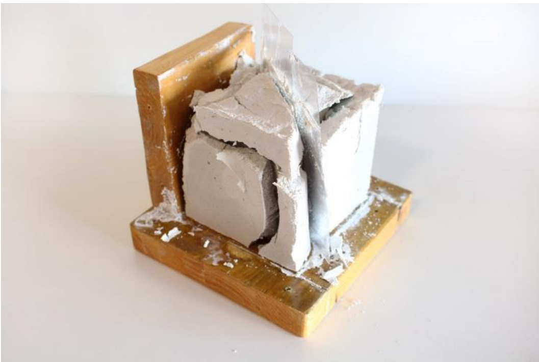
Figura 20: José Javier Ángeles Alejo. (2017) Estudio de la materia: Fases de moldeo con árido algínico . Fotografía digital. Comprobación de la materia aplicada sobre la superficie del modelo de plastilina.
