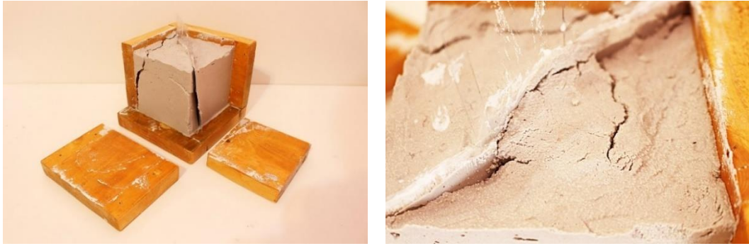
Figura 19: José Javier Ángeles Alejo. (2017) Estudio de la materia: Fases de moldeo con árido algínico . Fotografía digital. Apertura del encofrado de madera.
