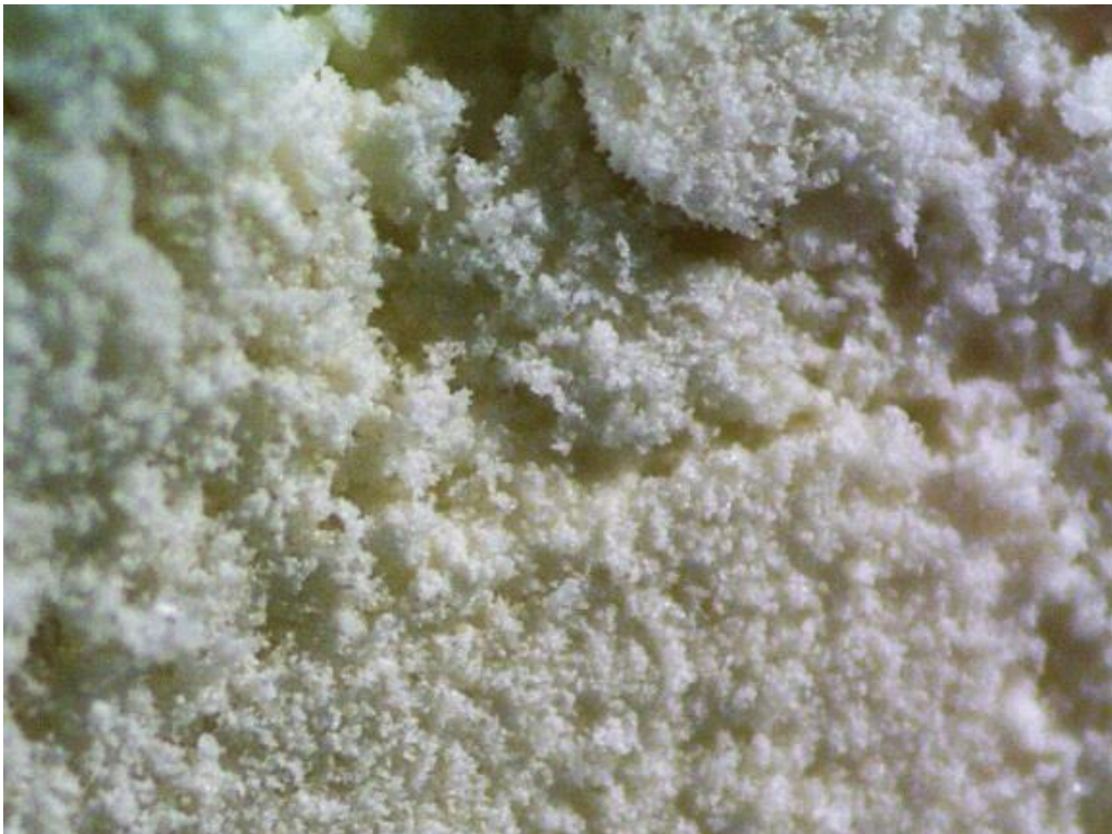
Figura 26: José Javier Ángeles Alejo. (2017) Observación superficial de árido algínico obtenido del alginato dental Orthoprint de Zhermack por medio de Microscópio Metalográfico Trinocular AmScope. Fotografía digital.
