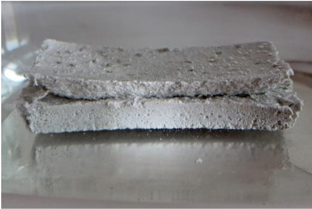
Figura 6: José Javier Ángeles Alejo. (2017) Probeta n°1 . Fotografía digital. Inicio del agrietamiento de la superficie. Aumento de volumen por absorción acompañado de rotura homogénea de la superficie por sus aristas.
