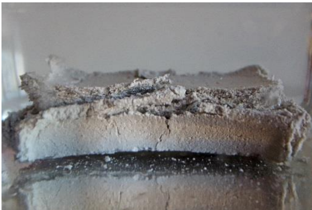
Figura 23: José Javier Ángeles Alejo. (2017) Probeta n°2 . Fotografía digital. Árido algínico reutilizado. Agrietamiento de la superficie y desprendimiento de materia de las zonas externas.
