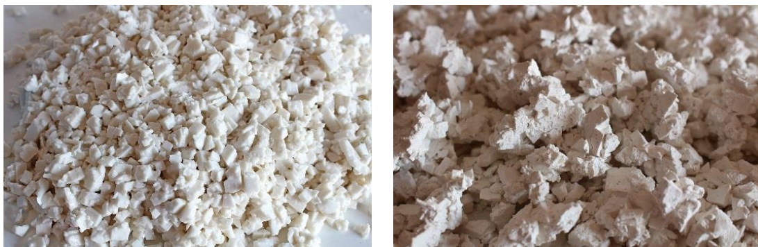
Figura 9: José Javier Ángeles Alejo. (2017) Proceso de secado de la materia . Fotografía digital. Izquierda: reducción de los fragmentos de alginato dental fraguado por medio de triturado manual. Derecha: fragmentos de alginato dental seco. Proceso de sinéresis concluido.
