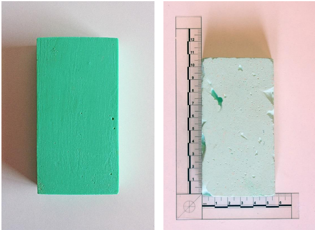
Figura 32: José Javier Ángeles Alejo. (2017) Izquierda: probeta n°6 . Fotografía digital. Alginato fraguado tras el proceso de gelificación. Derecha: probeta n°6 . Retracción de la materia tras el secado.
