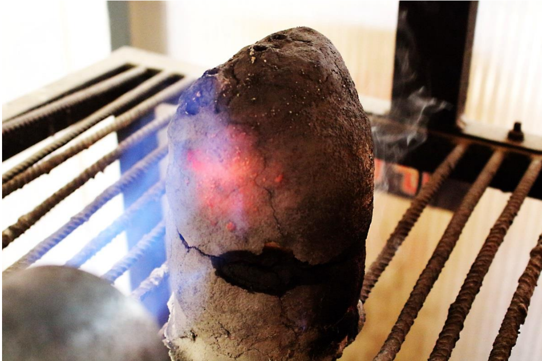
Figura 53: José Javier Ángeles Alejo. (2017) Estudio de la materia: Fases de moldeo con árido algúnico. Fotografía digital. Recocido de la masa que compone el molde para una mejor disgregación. Superficie al rojo vivo por acumulación de temperatura.
