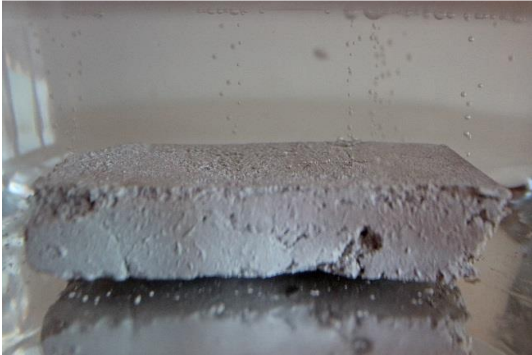
Figura 31: José Javier Ángeles Alejo. (2017) Probeta n°1 . Fotografía digital. Proceso de absorción de agua.
