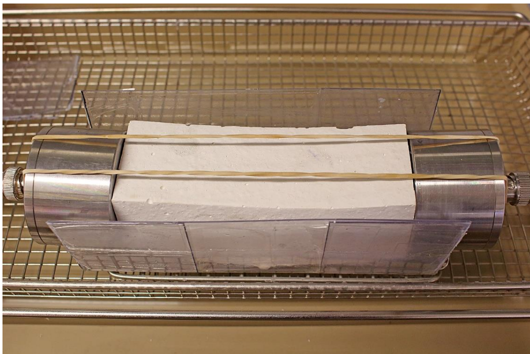
Figura 52: José Javier Ángeles Alejo. (2017) Medición de ultrasonidos por medio de un aparato TICO ultrasonic testing instrument.. Fotografía digital. Proceso de retracción de la materia.
