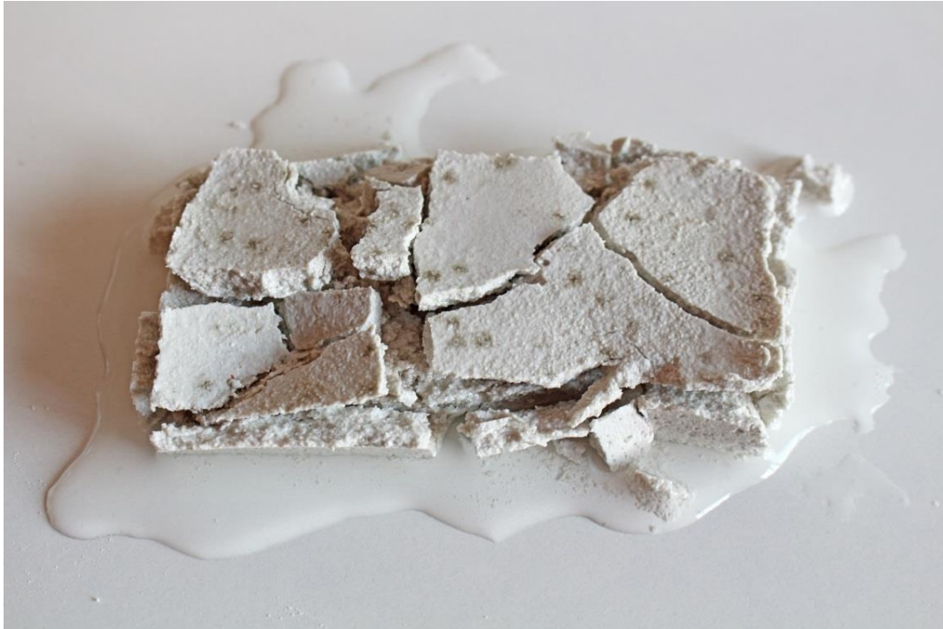
Figura 7: José Javier Ángeles Alejo. (2017) Probeta n°1. Absorción de agua concluida . Fotografía digital. Rotura de la pieza por contacto al recuperarla del recipiente de observación.
