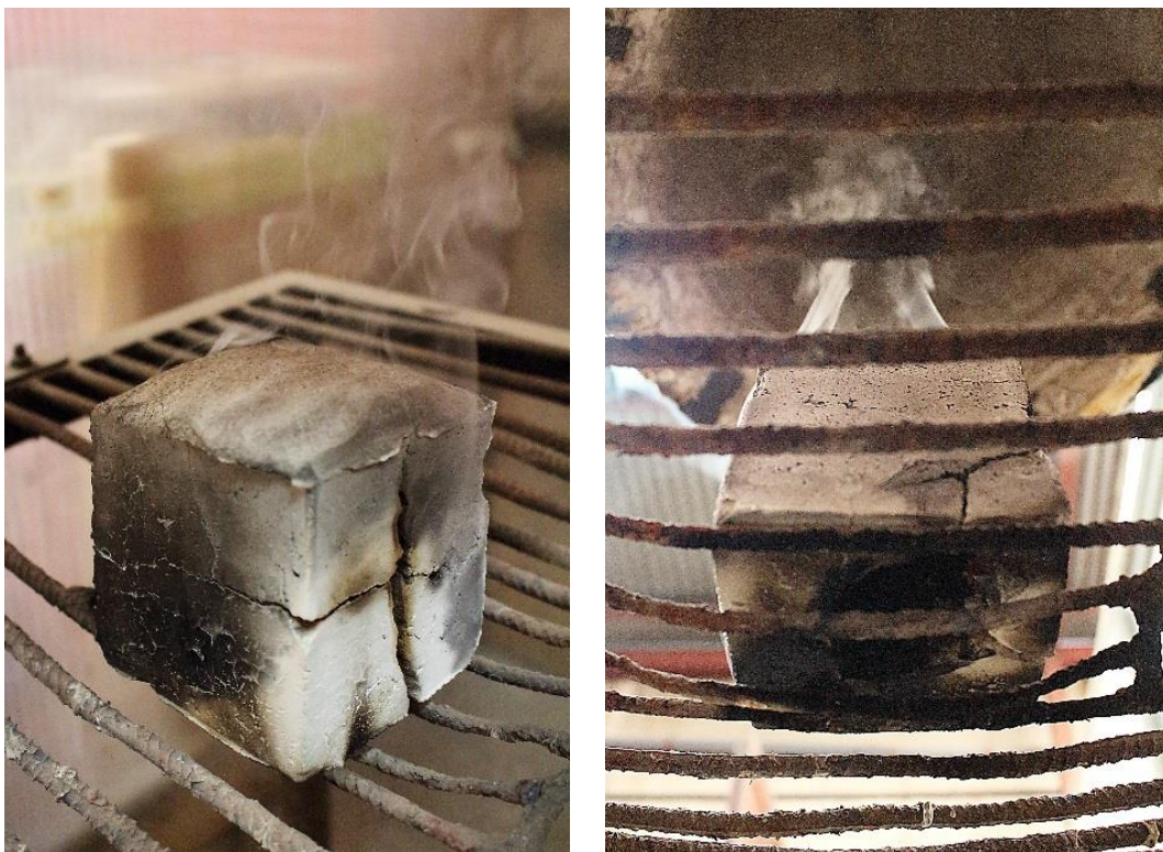
Figura 41: José Javier Ángeles Alejo. (2017) Estudio de la materia: Fases de moldeo con árido algínico . Fotografía digital. Cera extraída del interior del molde. Izquierda: enfriamiento de la superficie. Derecha: deshumado de la pieza durante la fase de enfriamiento.
