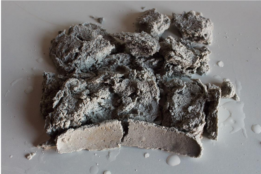
Figura 30: José Javier Ángeles Alejo. (2017) Probeta n°3 . Fotografía digital. Árido algínico reutilizado. Separación de fragmentos desprendidos.
