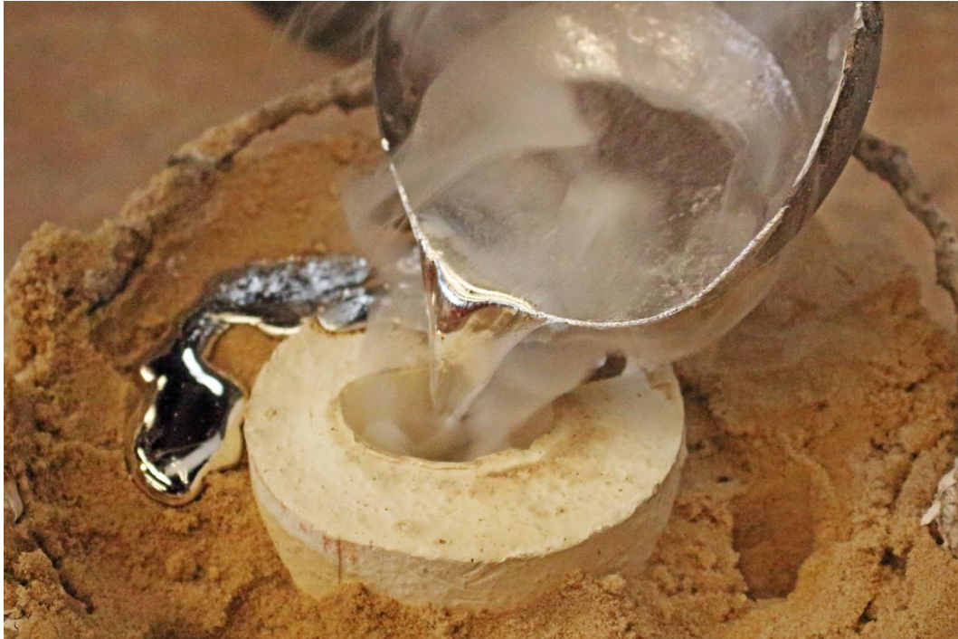
Figura 124: José Javier Ángeles Alejo. (2018) Vertido de zamak en el interior del molde de alginato deshidratado. Fotografía digital.
