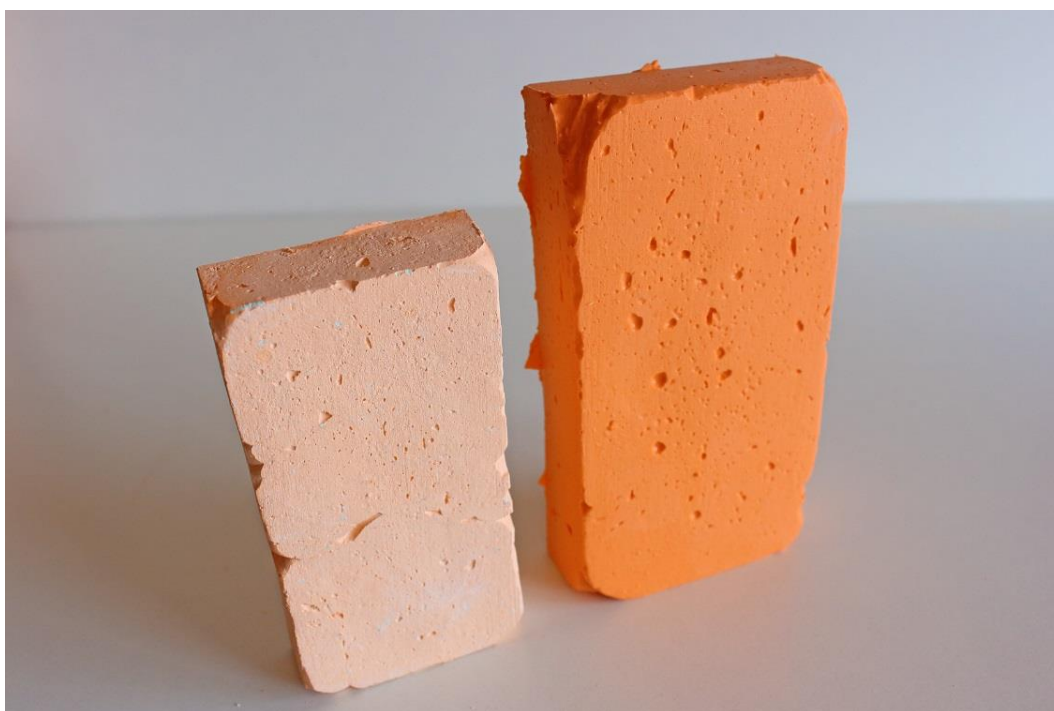
Figura 8: José Javier Ángeles Alejo. (2017) Observaciones de cambios dimensionales . Fotografía digital. Izquierda: alginato dental solidificado. Cambio dimensional producido por un proceso de sinéresis después del proceso de fraguado. Derecha: pieza de alginato dental recién fraguado.
