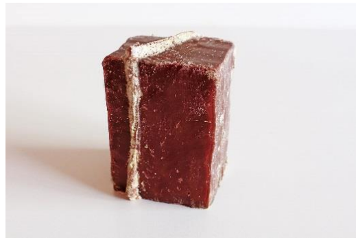
Figura 32: José Javier Ángeles Alejo. (2017) Estudio de la materia: Fases de moldeo con árido algínico . Fotografía digital. Disgregación total del molde. 2 horas desde la inmersión.
