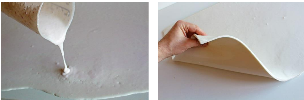
Figura 6: José Javier Ángeles Alejo. (2017) Proceso de fraguado del alginato . Fotografía digital. Izquierda: cambio de coloración del gel producido por la finalización de su fase de trabajo y aplicación. Derecha: finalización del proceso de fraguado.
