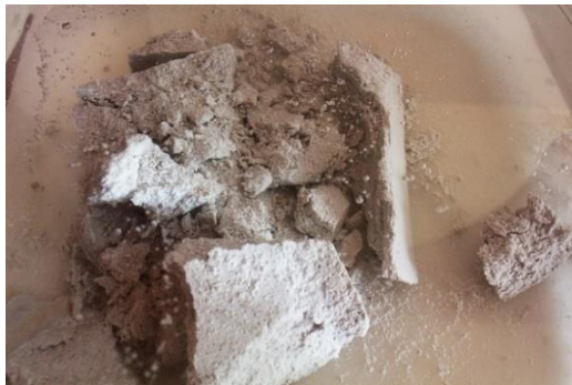
Figura 32: José Javier Ángeles Alejo. (2017) Estudio de la materia: Fases de moldeo con árido algínico . Fotografía digital. Disgregación total del molde. 2 horas desde la inmersión.
