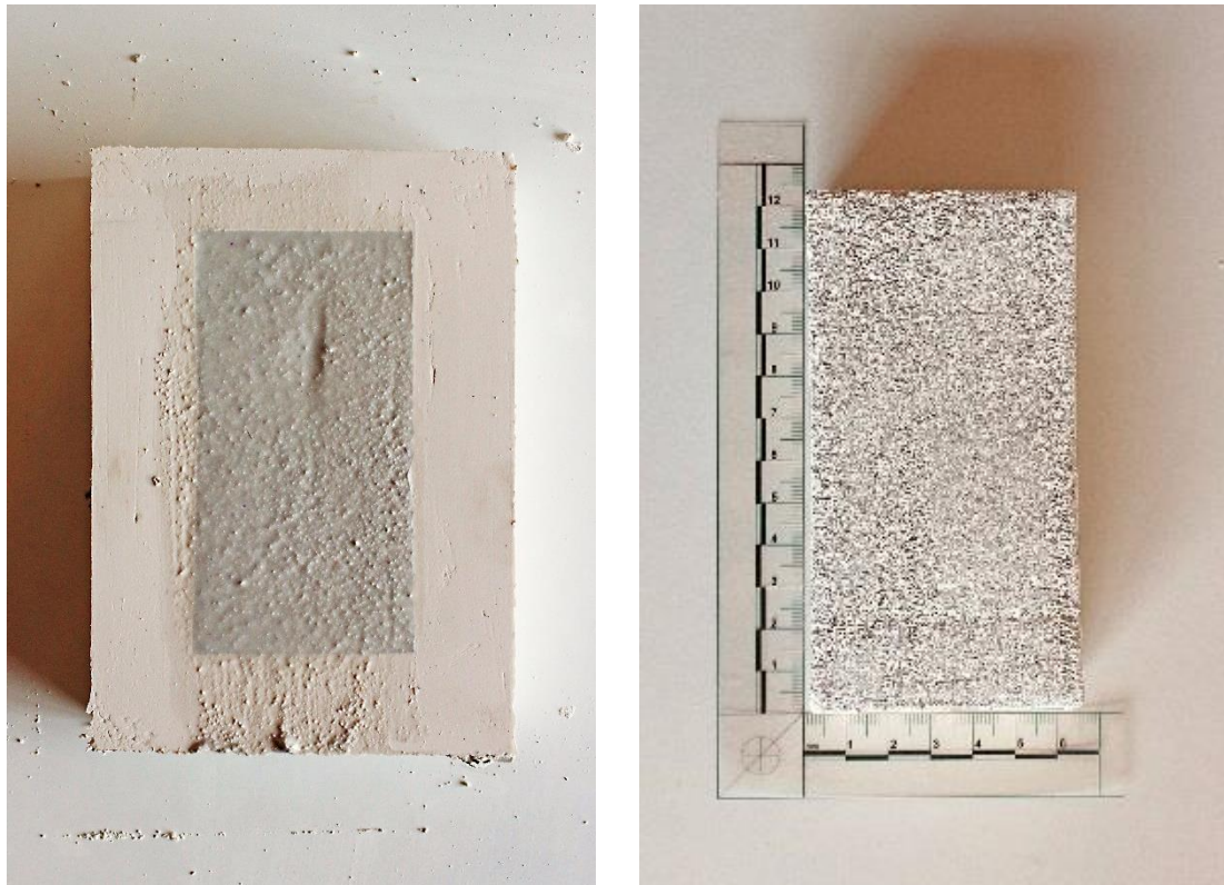
Figura 80: José Javier Ángeles Alejo. (2017) Izquierda: probeta n°5. Composición de árido algínico y escayola E-35 húmeda en el interior del molde de silicona. Derecha: probeta n°5 tras el proceso de fraguado. Fotografía digital.
