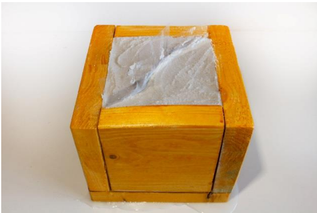
Figura 17: José Javier Ángeles Alejo. (2017) Estudio de la materia: Fases de moldeo con árido algínico. Fotografía digital. Aplicación de pasta de árido algínico como materia de moldeo.
