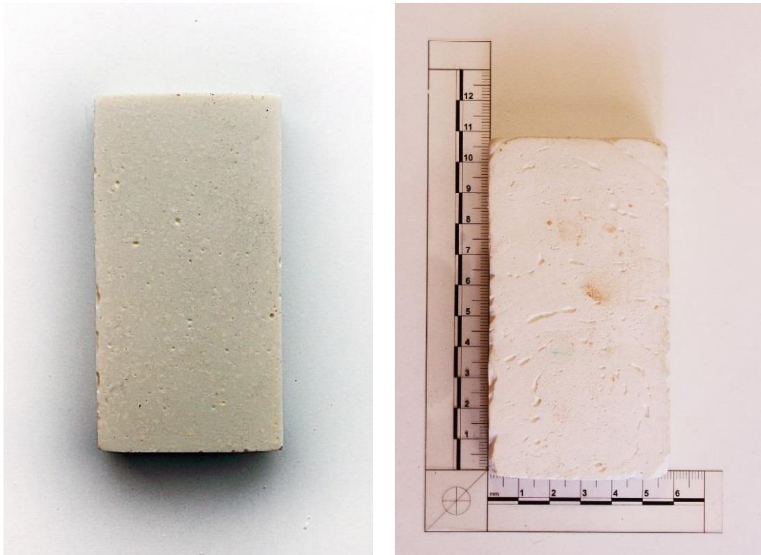
Figura 24: José Javier Ángeles Alejo. (2017) Izquierda: probeta n°2 . Fotografía digital. Alginato fraguado tras el proceso de gelificación. Derecha: probeta n°2 . Retracción de la materia tras el secado.
