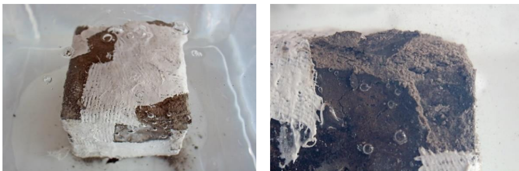
Figura 45: José Javier Ángeles Alejo. (2017) Estudio de la materia: Fases de moldeo con árido algínico . Fotografía digital. Izquierda: inicio de disgregación de la materia. Derecha: disgregación de la materia.
