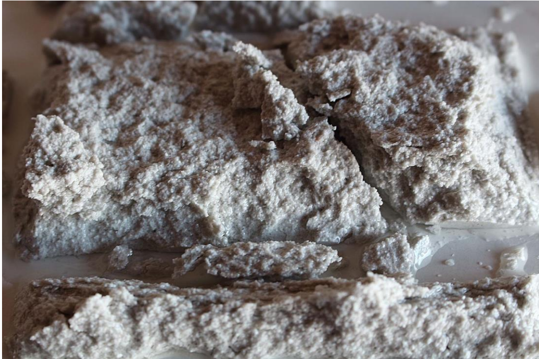
Figura 49: José Javier Ángeles Alejo. (2017) Probeta n°4 . Fotografía digital. Apreciación de los microgránulos saturados de agua.
