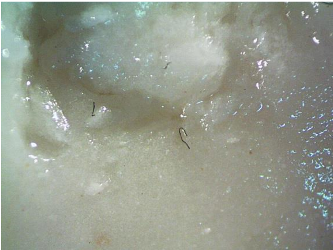
Figura 45: José Javier Ángeles Alejo. (2017) Vista superficial al Microscopio Metalográfico Trinocular Fotografía digital. Proceso de gelificación del alginato Phase Plus , de Zhermack . 3 minutos después de la gelificación.
