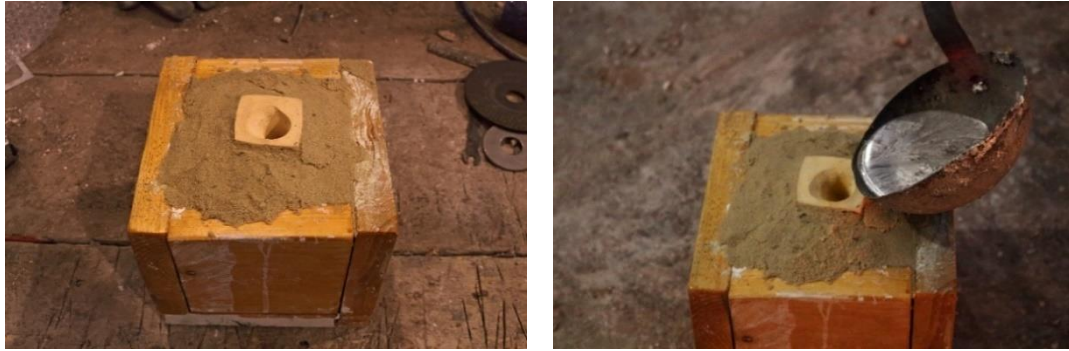
Figura 110: José Javier Ángeles Alejo. (2018) Reproducción de modelo de zamak a partir de molde de alginato dental. Fotografía digital. Izquierda: Molde de alginato dental revestido con arena de sílice. Derecha: vertido de zamak fundido en el interior del molde de alginato dental.
