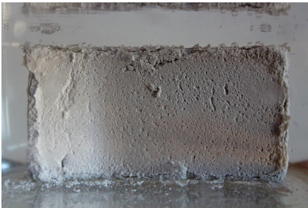
Figura 22: José Javier Ángeles Alejo. (2017) Probeta n°2 . Fotografía digital. Árido algínico reutilizado. Proceso de absorción de agua.
