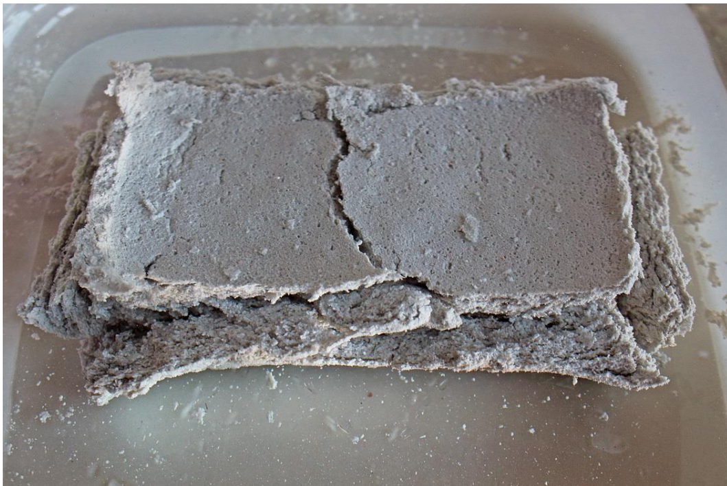
Figura 25: José Javier Ángeles Alejo. (2017) Probeta n°2 . Fotografía digital. Árido algínico reutilizado. Disgregación de la materia por absorción masiva de agua.
