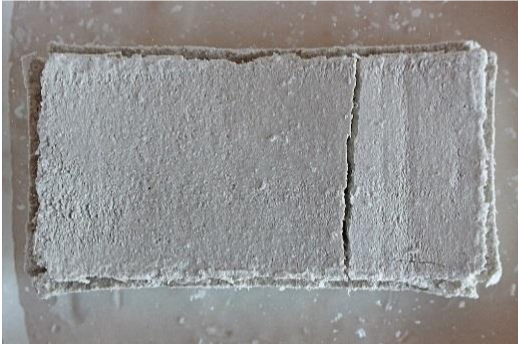
Figura 52: José Javier Ángeles Alejo. (2017) Probeta n°5 . Fotografía digital. Inicio de agrietamiento de las aristas.
