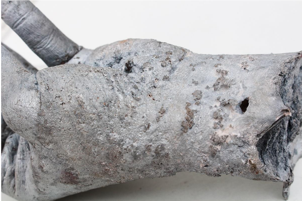
Figura 135: José Javier Ángeles Alejo. (2018) Mano reproducida en zamak. Fotografía digital. Desperfectos producidos por la presencia de agua en el molde de alginato dental.
