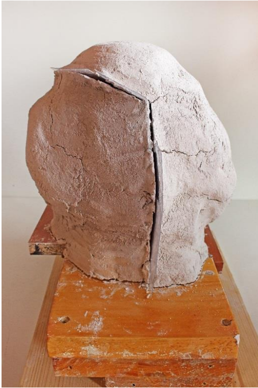
Figura 70: José Javier Ángeles Alejo. (2017) Estudio de la materia: Fases de moldeo con árido algínico . Fotografía digital. Inicio de apertura de las divisiones del molde por retracción de la materia producida por la pérdida de agua y el proceso de fraguado.
