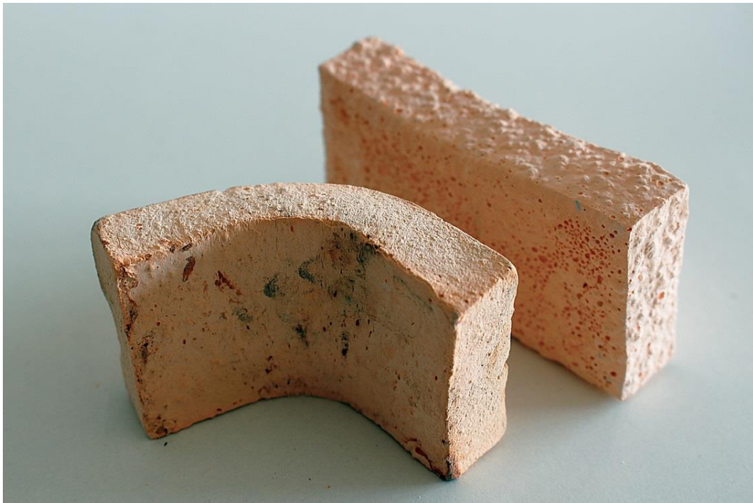
Figura 11: José Javier Ángeles Alejo. (2017) Cambios formales . Fotografía digital. Izquierda: deformación de pieza de alginato dental por evaporación de agua al aplicar temperatura en un punto fijo. Derecha: cambio dimensional sin deformación.
