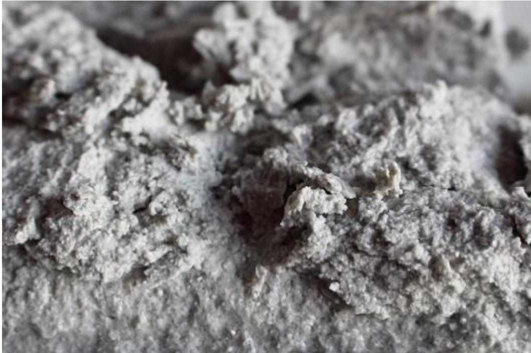
Figura 44: José Javier Ángeles Alejo. (2017) Probeta n°3 . Fotografía digital. Apreciación de los microgránulos saturados de agua.
