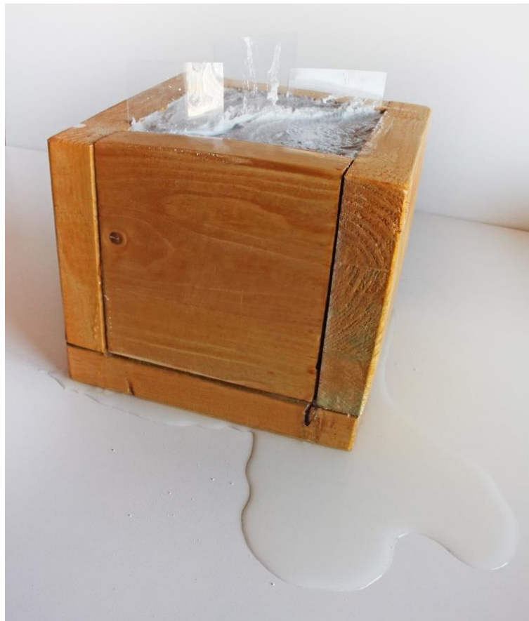
Figura 18: José Javier Ángeles Alejo. (2017) Estudio de la materia: Fases de moldeo con árido algínico . Fotografía digital. Expulsión de agua de la materia de moldeo. 3 minutos desde la aplicación.
