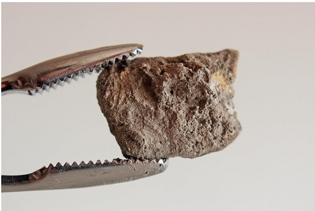
Figura 14: José Javier Ángeles Alejo. (2017) Prueba de inmersión . Fotografía digital. Detalle de uno de los fragmentos de la materia tras el proceso de solubilización y secado.
