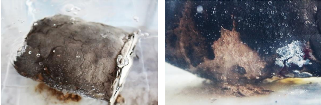
Figura 56: José Javier Ángeles Alejo. (2017) Estudio de la materia: Fases de moldeo con árido algínico . Fotografía digital. Izquierda: inicio de disgregación de la materia. Suspensión de partículas desprendidas de la superficie del molde. Derecha: disgregación de la materia.
