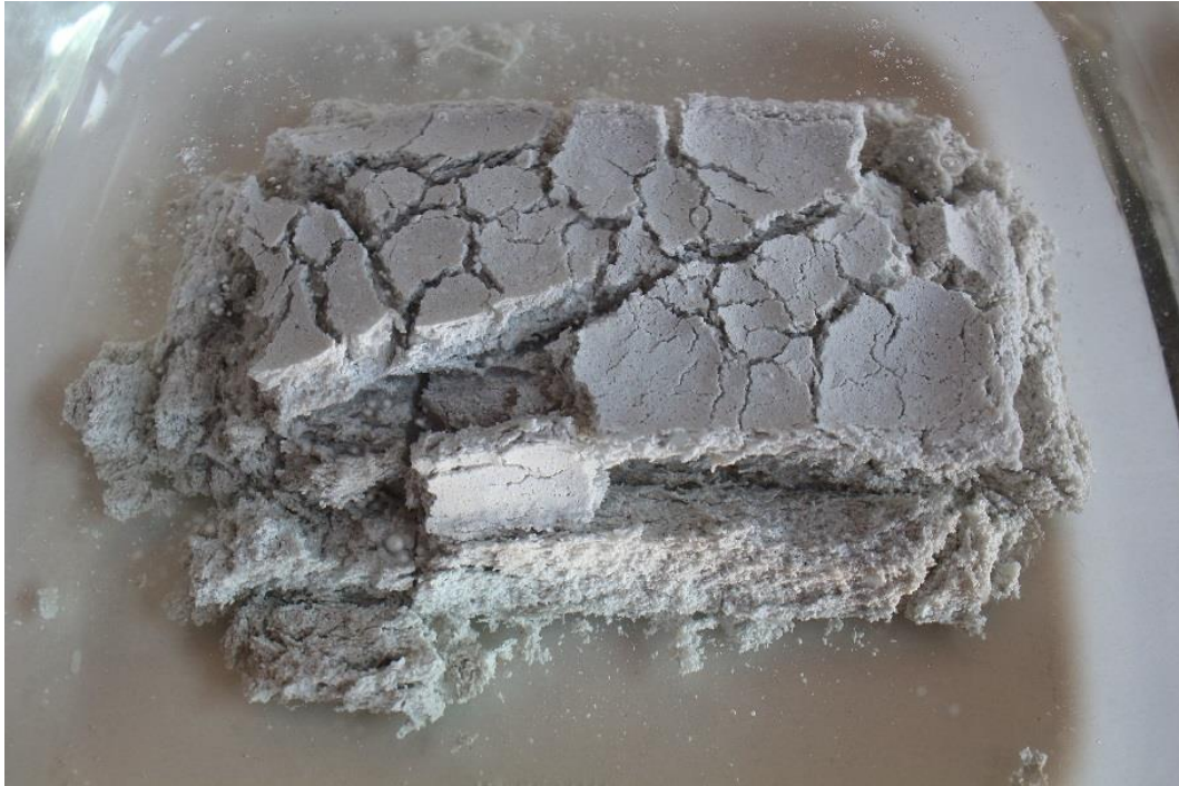
Figura 21: José Javier Ángeles Alejo. (2017) Probeta n°1 . Fotografía digital. Disgregación de la materia por absorción masiva de agua.
