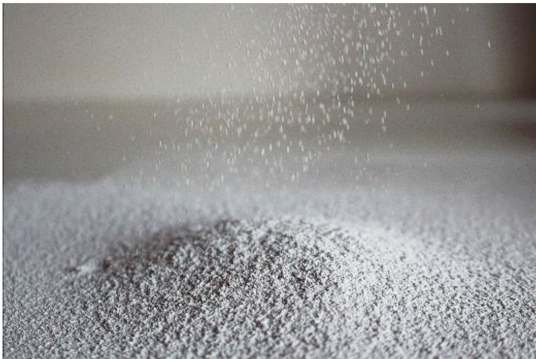
Figura 12: José Javier Ángeles Alejo. (2017) Árido algínico . Fotografía digital. Tamizado de los fragmentos triturados para la obtención de polvo con granulometría intangible.
