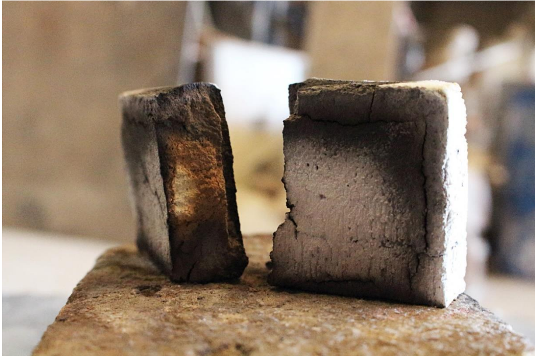
Figura 5: José Javier Ángeles Alejo. (2017) Prueba de combustión y resistencia térmica . Fotografía digital. Fractura de la pieza. Punto interno intacto.
