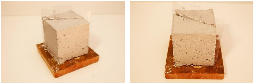
Figura 23: José Javier Ángeles Alejo. (2017) Estudio de la materia: Fases de moldeo con árido algínico . Fotografía digital. Apertura del encofrado y comprobación del proceso de retracción.
