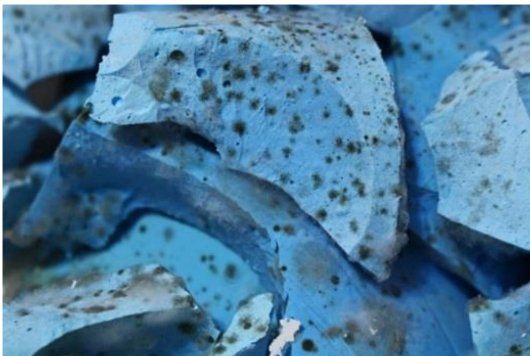
Figura 13: José Javier Ángeles Alejo. (2017) Deterioro por humedad . Fotografía digital. Aparición de moho cinco días después del proceso de fraguado.
