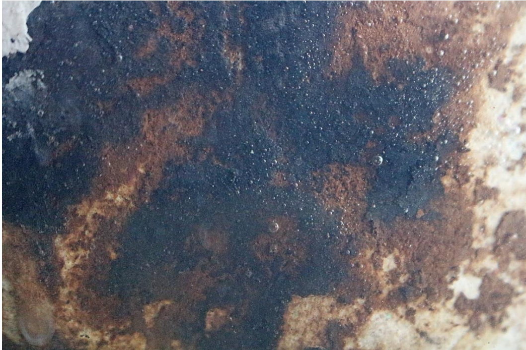
Figura 81: José Javier Ángeles Alejo. (2017) Estudio de la materia: Fases de moldeo con árido algínico . Fotografía digital. Inicio de aparición de burbujas por la expulsión de oxígeno del interior de la materia.
