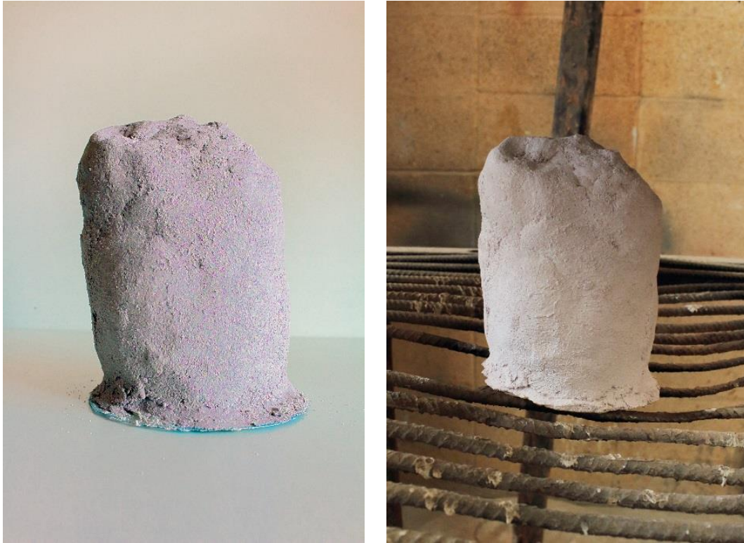
Figura 51: José Javier Ángeles Alejo. (2017) Estudio de la materia: Fases de moldeo con árido algínico. Fotografía digital. Izquierda: pieza de cera revestida de mortero compuesto por árido algínico, escayola E-35 y talco. Derecha: colocación del molde en la campana de extracción de cera.
