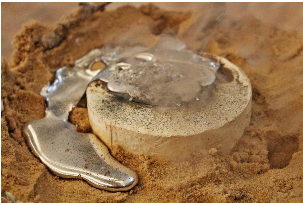
Figura 125: José Javier Ángeles Alejo. (2018) Fase de vertido completada. Enfriamiento y solidificación de la materia. Fotografía digital.
