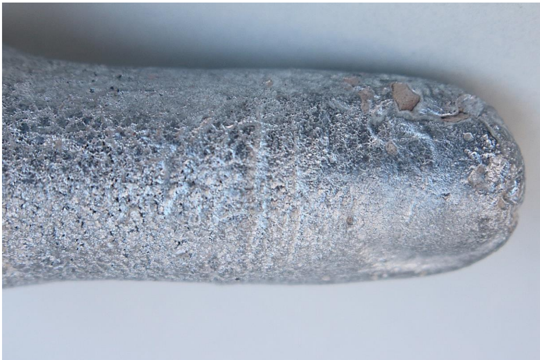
Figura 116: José Javier Ángeles Alejo. (2018) Reproducción en zamak n°2. Fotografía digital. Fragmentos de molde incrustados en la propia reproducción. Detalle.
