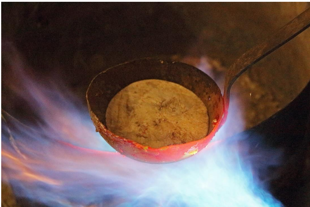
Figura 109: José Javier Ángeles Alejo. (2018) Fundición de zamak a 400° para vertido en el interior del molde de alginato. Fotografía digital.
