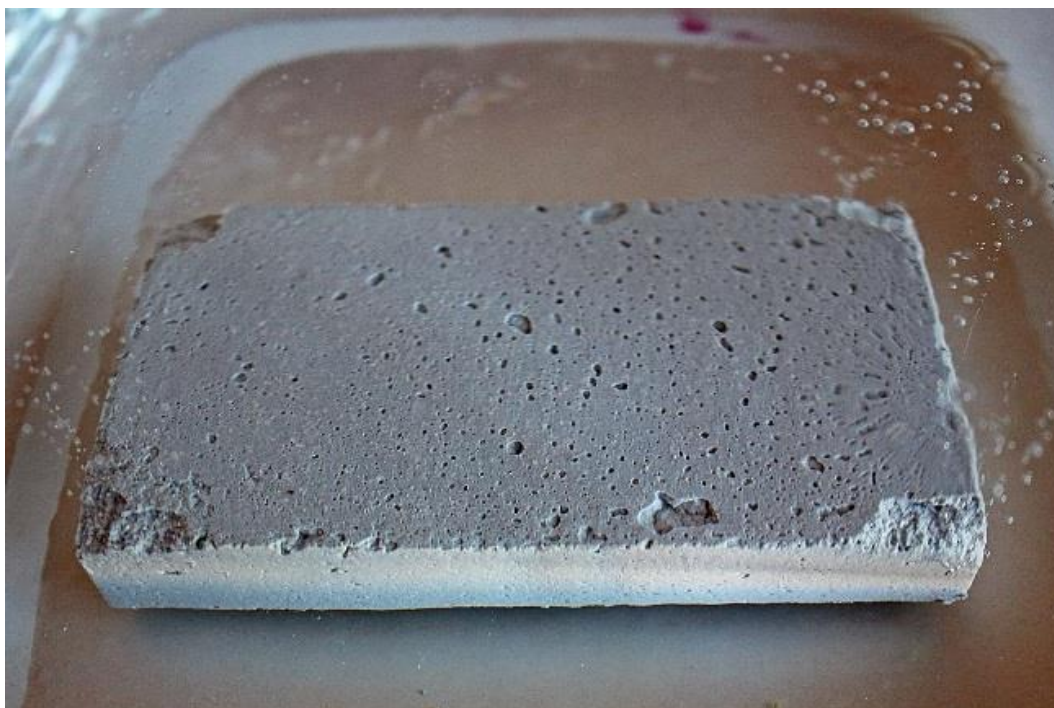
Figura 40: José Javier Ángeles Alejo. (2017) Probeta n°3 . Fotografía digital. Proceso de absorción de agua.
