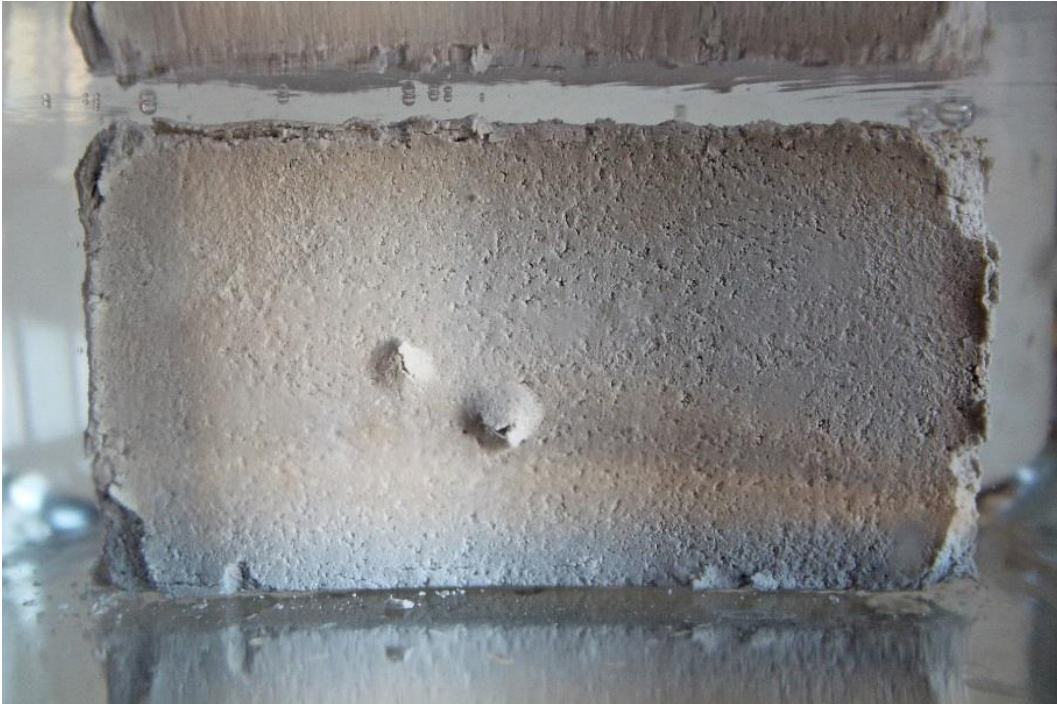
Figura 26: José Javier Ángeles Alejo. (2017) Probeta n°3 . Fotografía digital. Árido algínico reutilizado. Proceso de absorción de agua.
