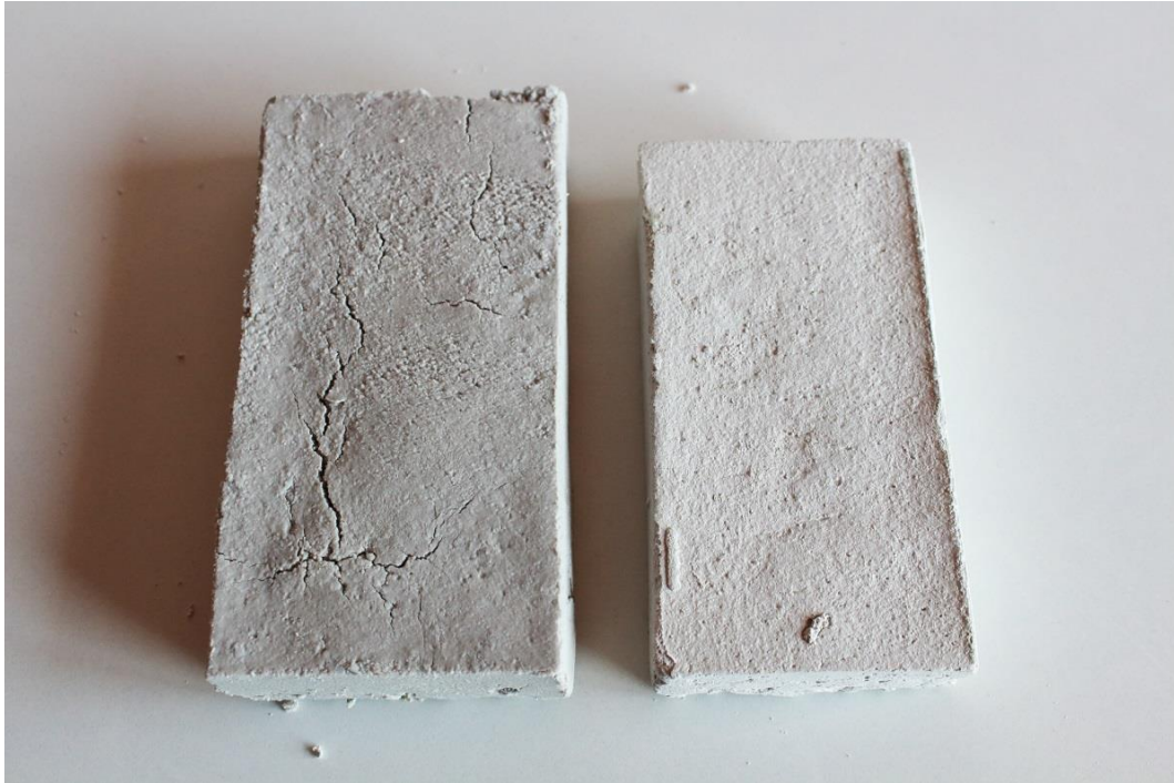
Figura 19: José Javier Ángeles Alejo. (2017) Comparativa . Fotografía digital. Izquierda: probeta de pasta de árido algínico antes de perder el agua. Dimensiones: 125mm x 65mm x 25mm. Derecha: probeta de pasta de árido algínico tras el secado.
