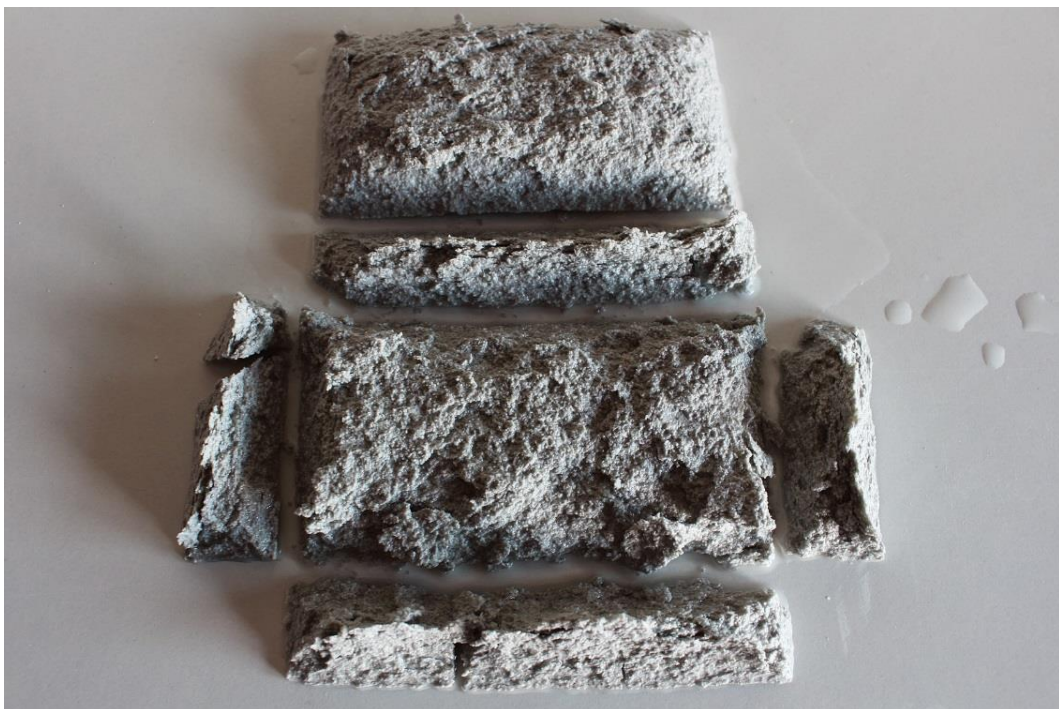
Figura 16: José Javier Ángeles Alejo. (2017) Probeta n°3 . Fotografía digital. Separación manual de fragmentos regulares producidos por absorción de agua.
