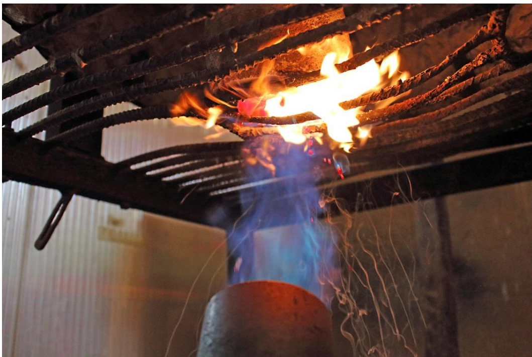
Figura 52: José Javier Ángeles Alejo. (2017) Estudio de la materia: Fases de moldeo con árido algínico. Fotografía digital. Expulsión de cera del interior del molde.
