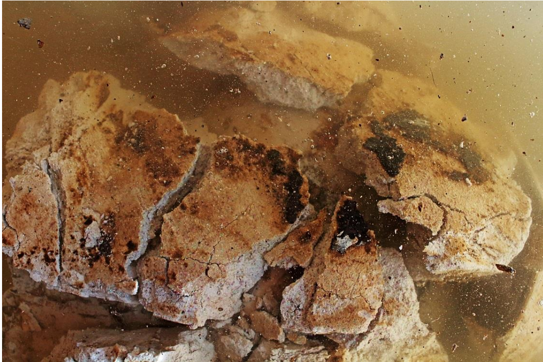
Figura 87: José Javier Ángeles Alejo. (2017) Estudio de la materia: Fases de moldeo con árido algínico . Fotografía digital. Separación progresiva de los fragmentos. Vista de la reproducción de escayola del interior del molde.
