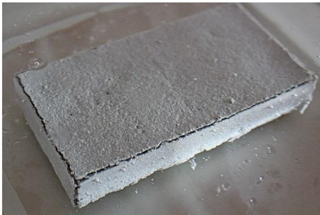
Figura 14: José Javier Ángeles Alejo. (2017) Probeta n°3 . Fotografía digital. Izquierda: absorción de agua. Ligero desprendimiento de partículas por agrietamiento. Derecha: inicio del agrietamiento de la superficie.
