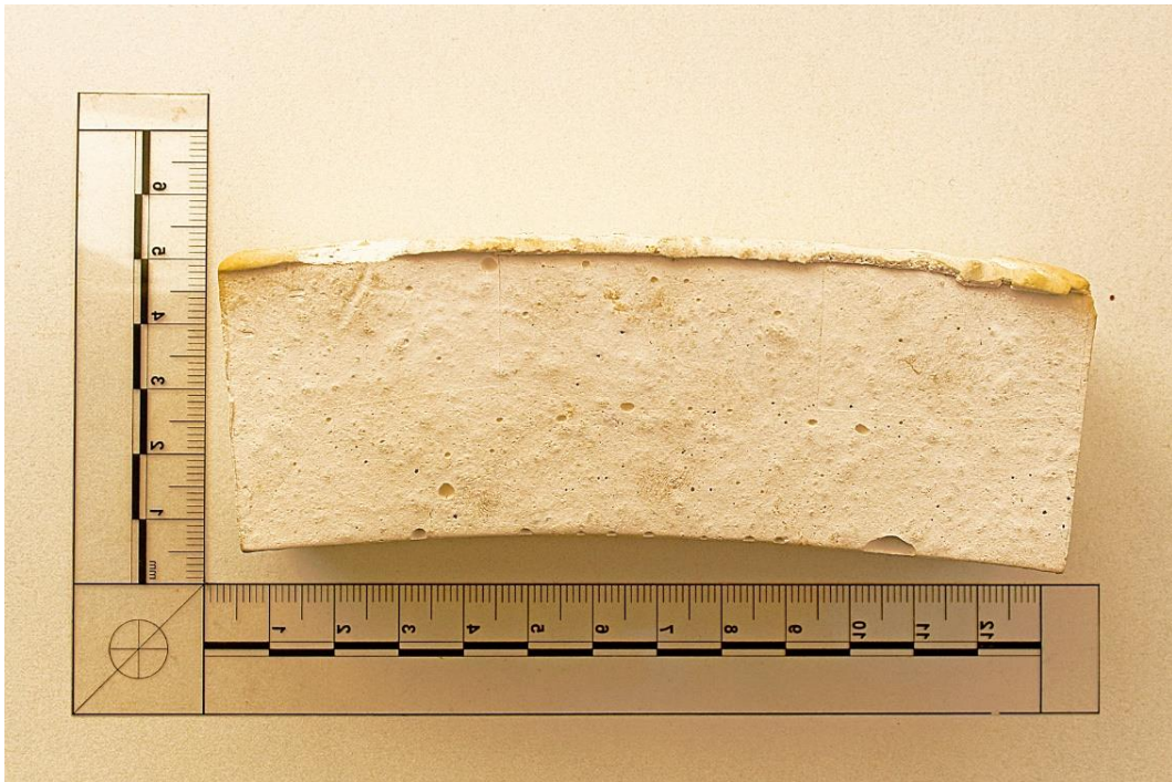
Figura 53: José Javier Ángeles Alejo. (2018) Alginato dental fraguado y seco . Fotografía digital. Prueba de ultrasonidos. Extracción de la materia del recipiente tras concluir las mediciones de ultrasonidos.
