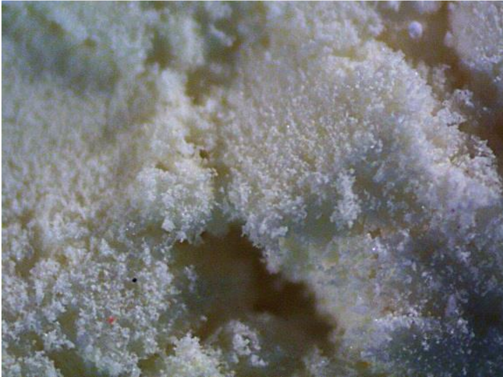
Figura 25: José Javier Ángeles Alejo. (2017) Observación superficial de alginato dental Orthoprint de Zhermack por medio de Microscópio Metalográfico Trinocular AmScope. Fotografía digital.
