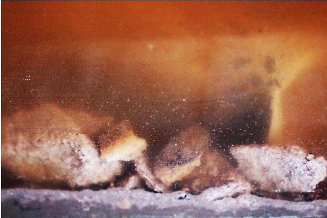
Figura 58: José Javier Ángeles Alejo. (2017) Estudio de la materia: Fases de moldeo con árido algínico . Fotografía digital. Decantación del agua. Agrupación de residuos carbonizados en el fondo del recipiente. Pieza extraída del molde.
