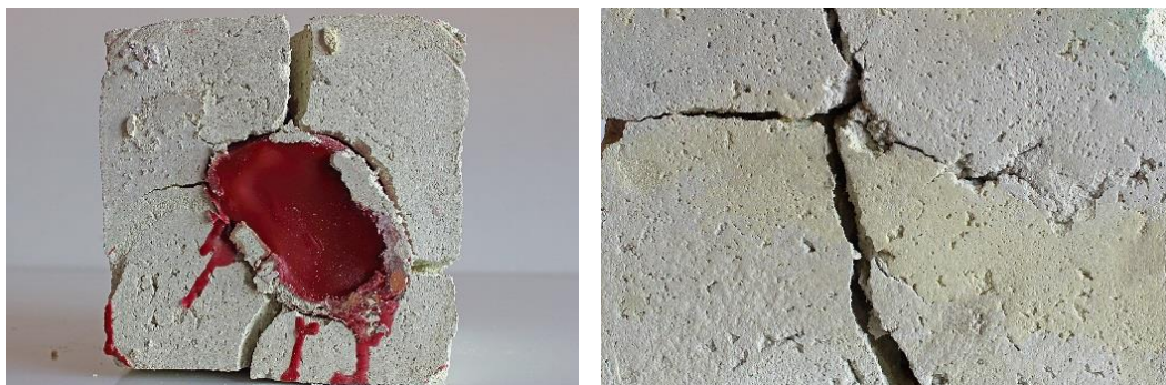
Figura 38: José Javier Ángeles Alejo. (2017) Estudio de la materia: Fases de moldeo con árido algínico . Fotografía digital. Izquierda: bebedero y agrietado por retracción. Derecha: superficie agrietada a consecuencia del proceso de retracción.
