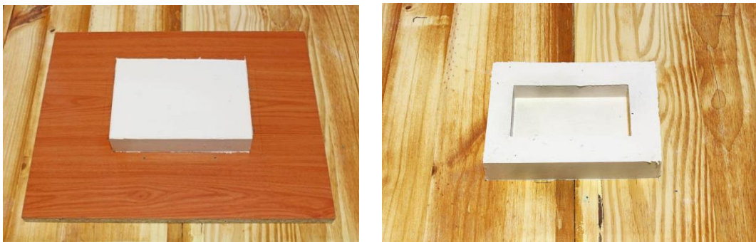
Figura 3: José Javier Ángeles Alejo. (2017) Realización de molde de silicona . Fotografía digital. Izquierda: desmontaje del encofrado para la obtención del molde. Derecha: molde de silicona para la reproducción sucesiva de probetas.
