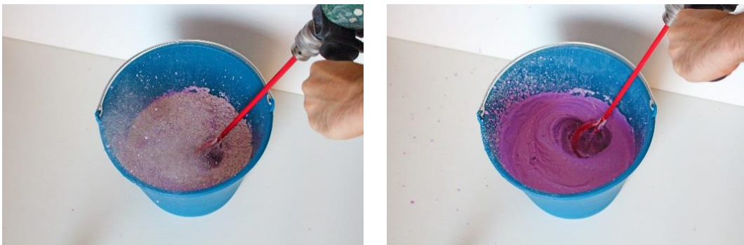
Figura 4: José Javier Ángeles Alejo. (2017) Obtención del gel . Fotografía digital. Izquierda: fase de mezcla del alginato con agua con ayuda de taladro y hélice. Derecha: gelificación del alginato. Inicio de coloración púrpura de la materia correspondiente a la fase de trabajo o manipulación.
