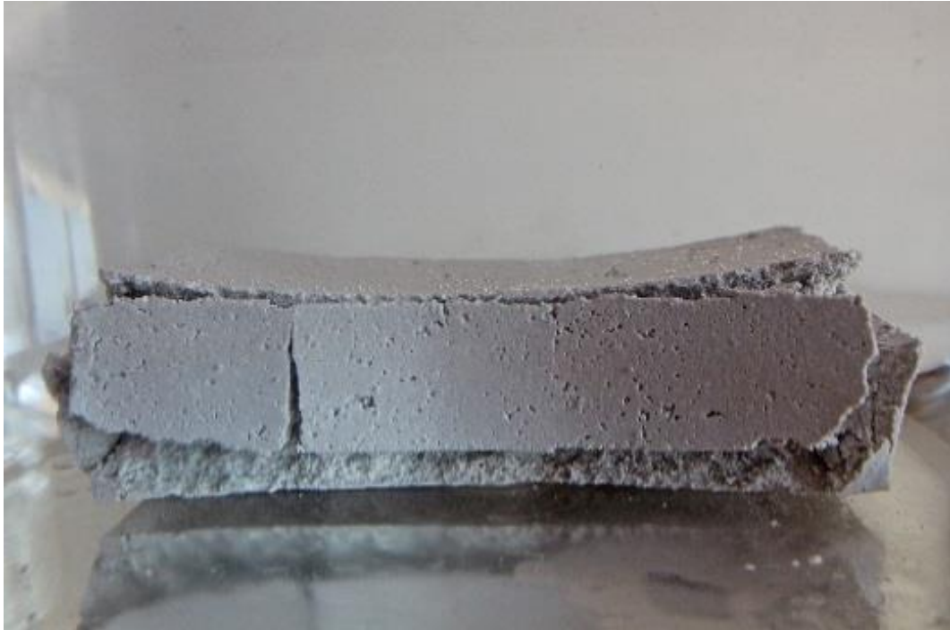
Figura 38: José Javier Ángeles Alejo. (2017) Probeta n°2 . Fotografía digital. Agrietamiento y rotura de la superficie por absorción de agua.
