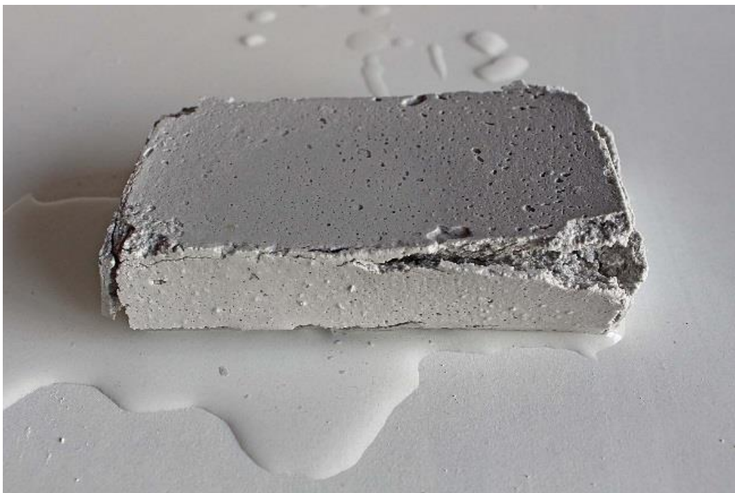
Figura 43: José Javier Ángeles Alejo. (2017) Probeta n°3 . Fotografía digital. Deformación total de la superficie por absorción masiva de agua.
