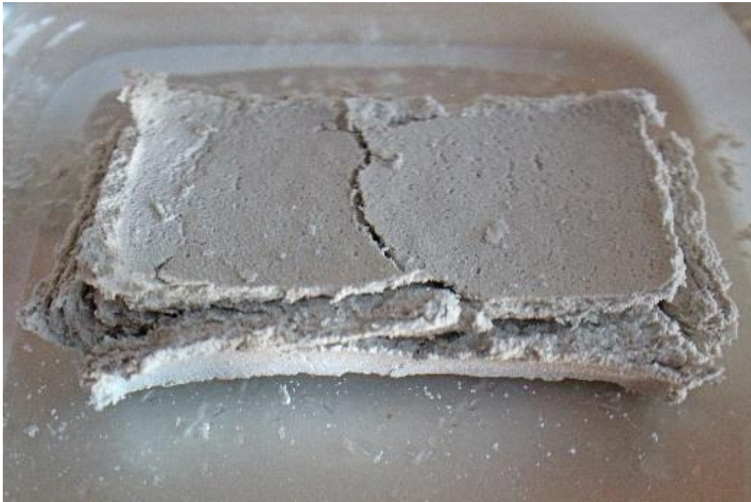
Figura 24: José Javier Ángeles Alejo. (2017) Probeta n°2 . Fotografía digital. Árido algínico reutilizado. Agrietamiento de la superficie y desprendimiento de materia de las zonas externas.
