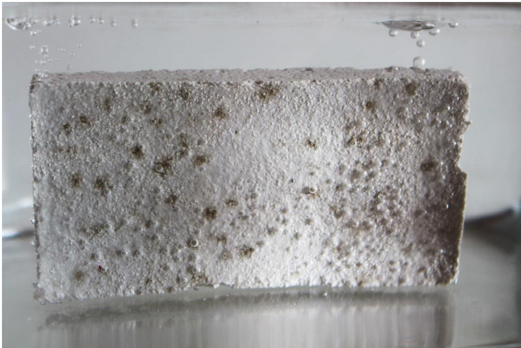
Figura 5: José Javier Ángeles Alejo. (2017) Probeta n°1. Proceso de absorción de agua. Fotografía digital.
