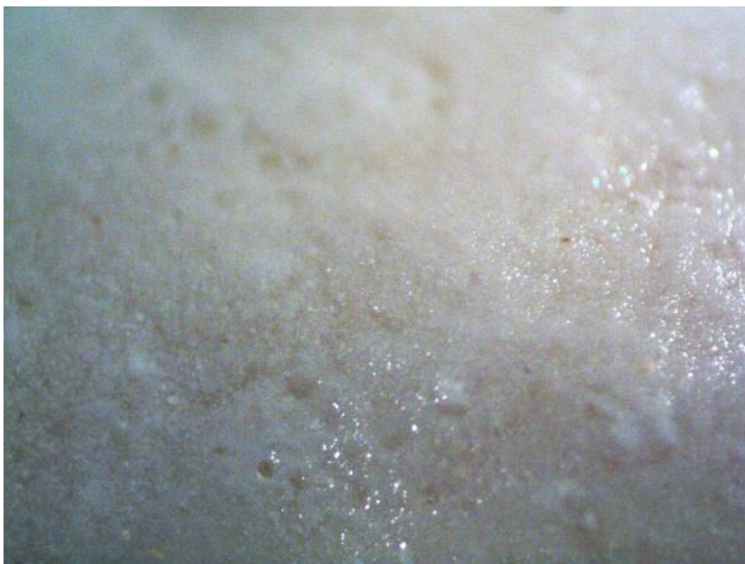
Figura 44: José Javier Ángeles Alejo. (2017) Vista superficial al Microscopio Metalográfico Trinocular . Fotografía digital. Proceso de gelificación del alginato Phase Plus , de Zhermack . 20 segundos de la mezcla con agua.
