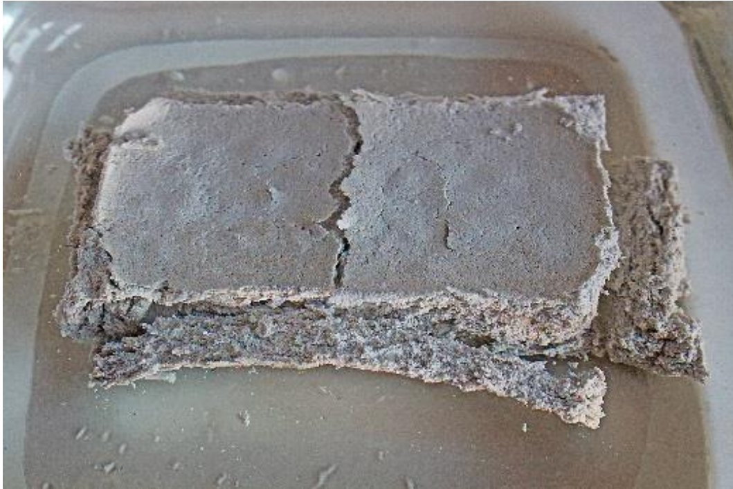
Figura 28: José Javier Ángeles Alejo. (2017) Probeta n°3 . Fotografía digital. Árido algínico reutilizado. Agrietamiento y desprendimiento de fragmentos en las aristas. Fractura de la superficie.
