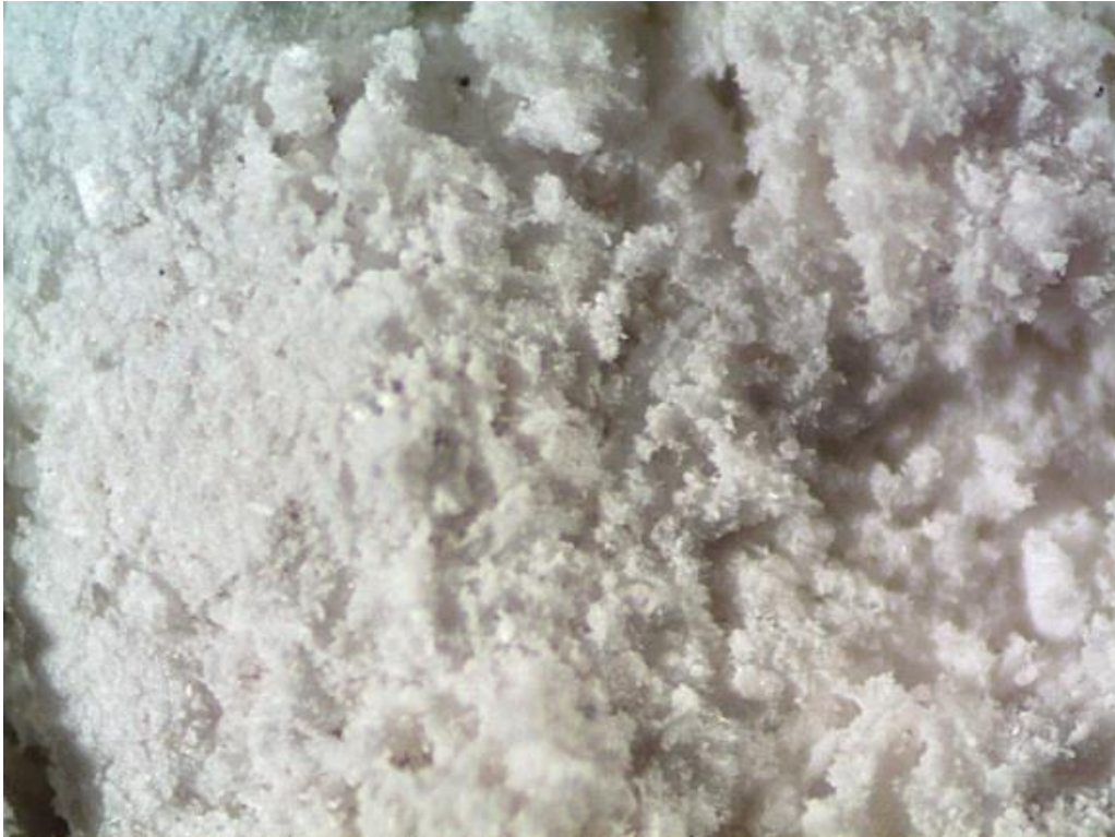
Figura 21: José Javier Ángeles Alejo. (2017) Observación superficial de escayola E-35 por medio de Microscópio Metalográfico Trinocular AmScope. Fotografía digital.
