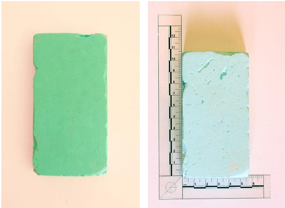
Figura 30: José Javier Ángeles Alejo. (2017) Izquierda: probeta n°5 . Fotografía digital. Alginato fraguado tras el proceso de gelificación. Derecha: probeta n°5 . Retracción de la materia tras el secado.
