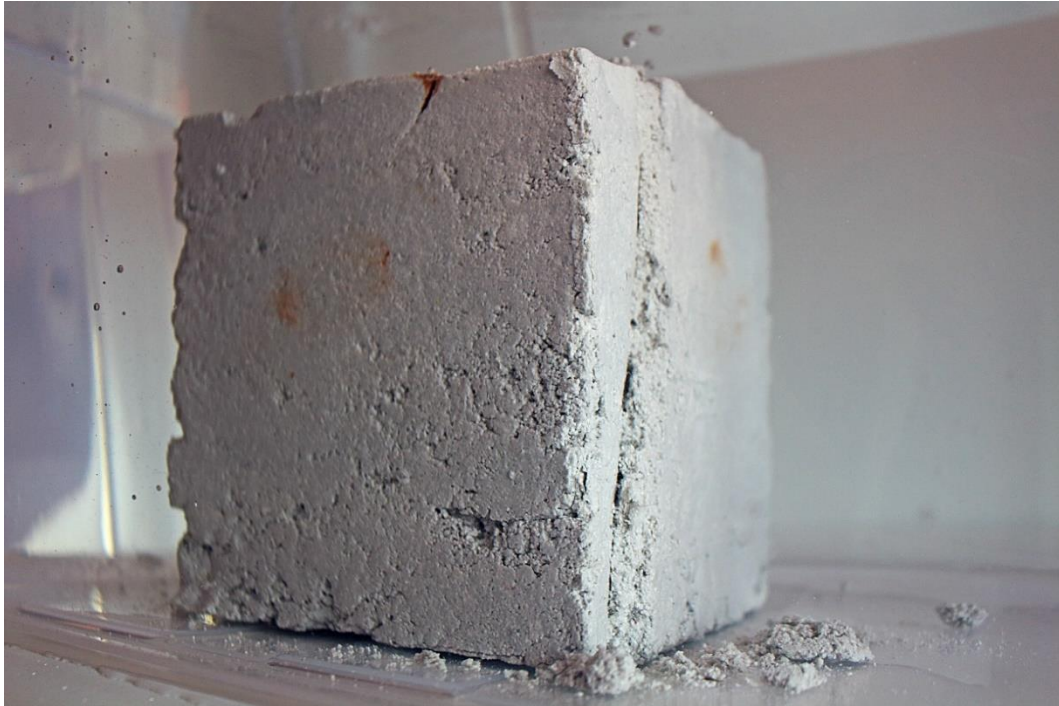
Figura 29: José Javier Ángeles Alejo. (2017) Estudio de la materia: Fases de moldeo con árido algínico. Fotografía digital. Proceso de inmersión. Absorción de agua. 3 minutos desde la inmersión.
