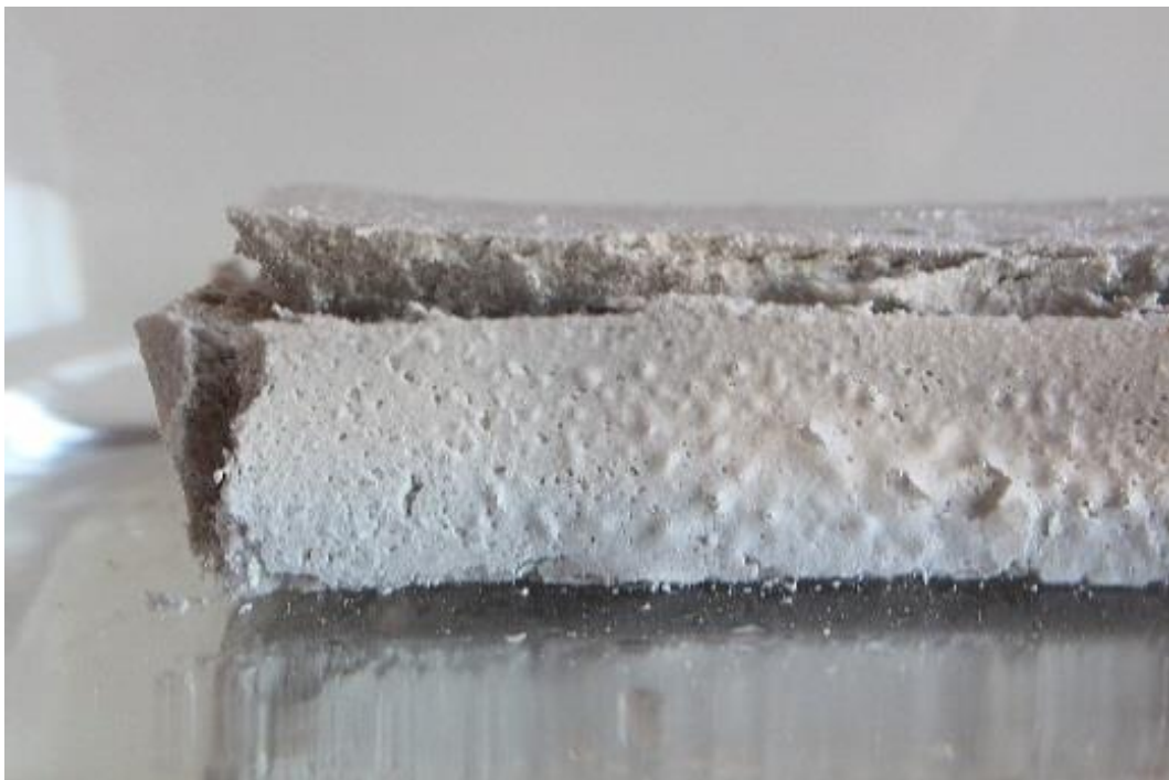
Figura 58: José Javier Ángeles Alejo. (2017) Probeta n°6 . Fotografía digital. Inicio de separación de la probeta en fragmentos regulares.
