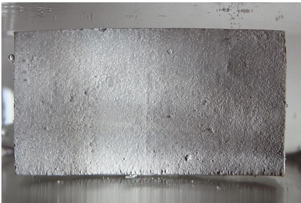
Figura 13: José Javier Ángeles Alejo. (2017) Probeta n°3 . Fotografía digital. Proceso de absorción de agua.
