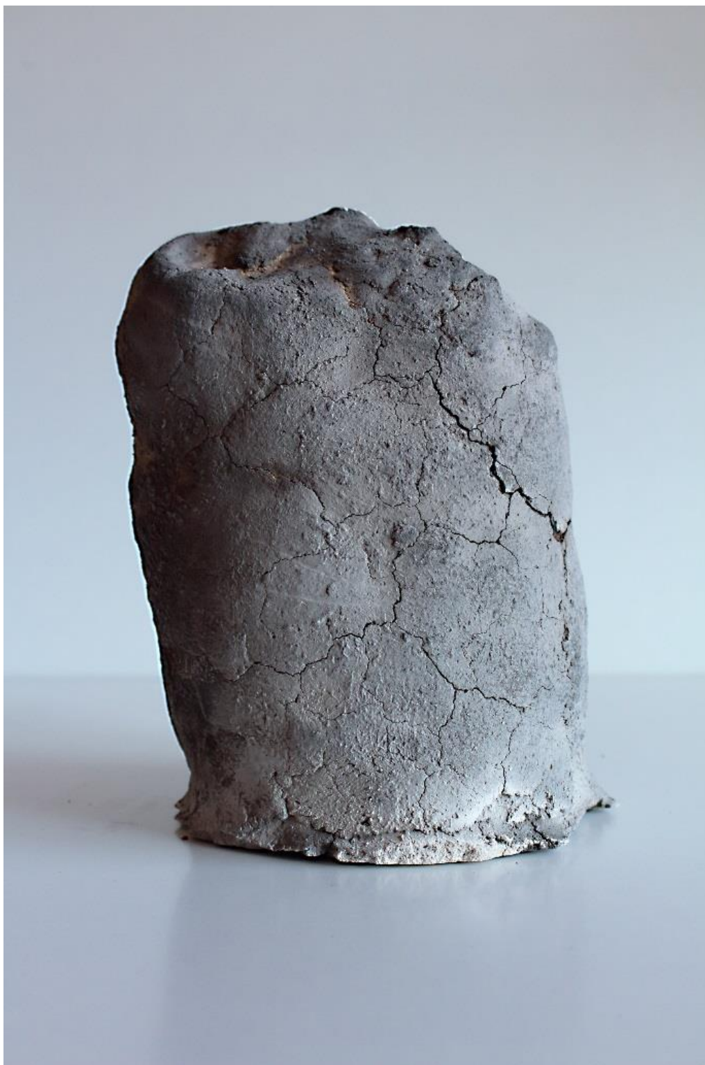
Figura 55: José Javier Ángeles Alejo. (2017) Estudio de la materia: Fases de moldeo con árido algínico. Fotografía digital. Molde recocido. Superficie carbonizada durante el proceso de extracción de cera.
