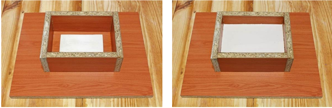
Figura 2: José Javier Ángeles Alejo. (2017) Realización de molde de silicona . Fotografía digital. Izquierda: encofrado de la probeta inicial de escayola para el vertido de silicona. Derecha: vertido de silicona en el encofrado hasta su maduración.
