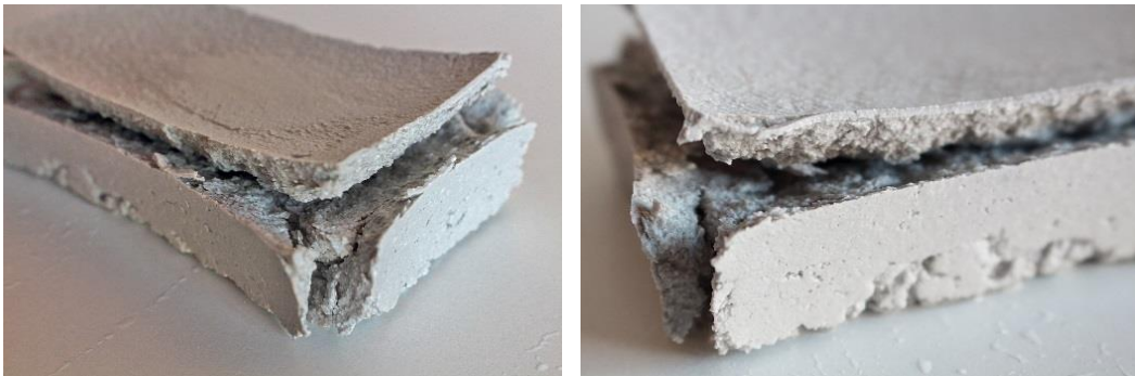
Figura 11: José Javier Ángeles Alejo. (2017) Probeta n°2 . Fotografía digital. Fotografía detalle. Rotura homogénea y apertura de la superficie por sus aristas.
