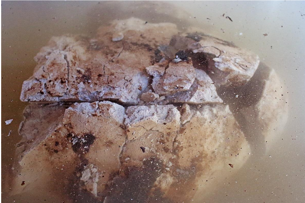
Figura 85: José Javier Ángeles Alejo. (2017) Estudio de la materia: Fases de moldeo con árido algínico. Fotografía digital. Rotura superficial en fragmentos por absorción masiva de agua.
