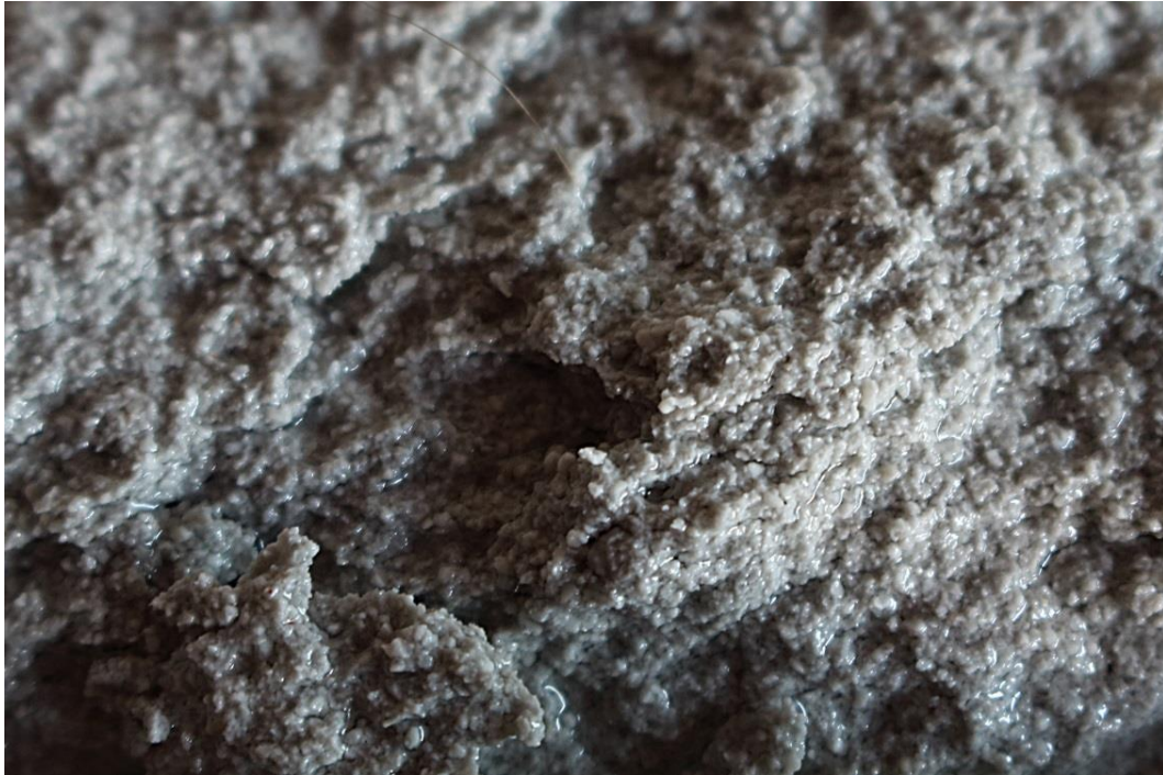
Figura 17: José Javier Ángeles Alejo. (2017) Probeta n°3 . Fotografía digital. Fotografía detalle. Interior de la pieza embebido por absorción de agua.
