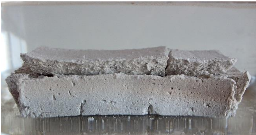
Figura 53: José Javier Ángeles Alejo. (2017) Probeta n°5 . Fotografía digital. Aumento de volumen por absorción masiva de agua. Deformación y rotura por absorción masiva de agua.
