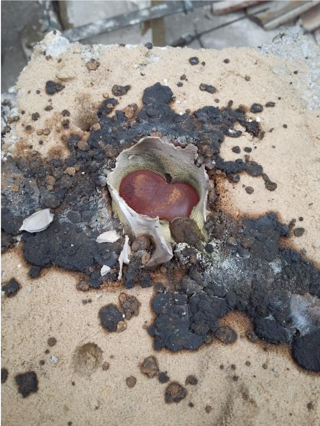
Figura 138: José Javier Ángeles Alejo. (2018) Bronce solidificado en el interior del molde de alginato. Fase de enfriamiento. Fotografía digital.
