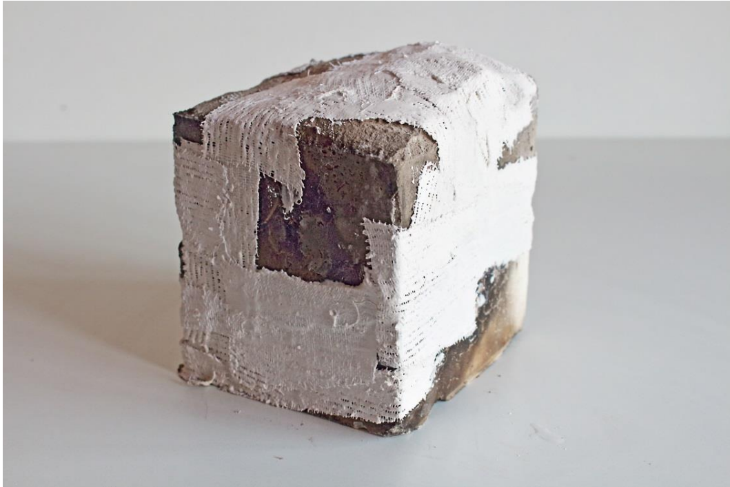
Figura 42: José Javier Ángeles Alejo. (2017) Estudio de la materia: Fases de moldeo con árido algínico . Fotografía digital. Molde realizado con de mortero compuesto de árido algínico y escayola E-35. Aplicación de venda de escayola para asegurar las zonas agrietadas.
