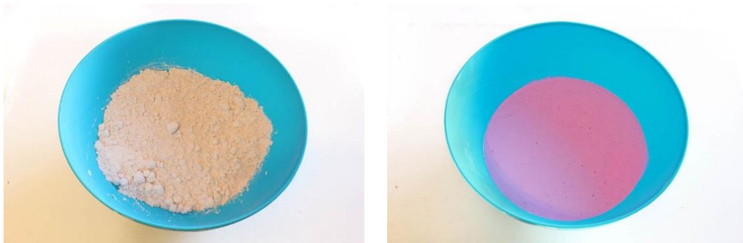
Figura 17: José Javier Ángeles Alejo. (2017) Cambios de estado . Fotografía digital. Izquierda: alginato dental en estado pulverulento. Ligera coloración rosácea. Derecha: fase de mezclado realizada. Contraste púrpura.
