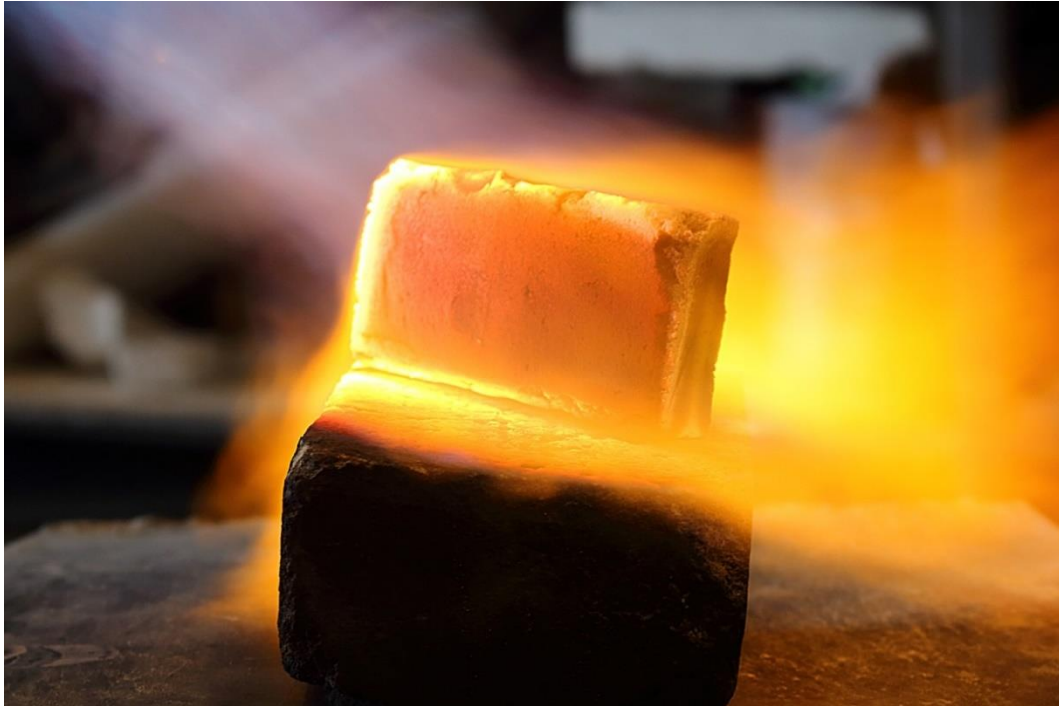
Figura 3: José Javier Ángeles Alejo. (2017) Prueba de combustión y resistencia térmica. Fotografía digital. Aumento gradual de temperatura hasta alcanzar los 800° C / 900° C. 10 minutos.
