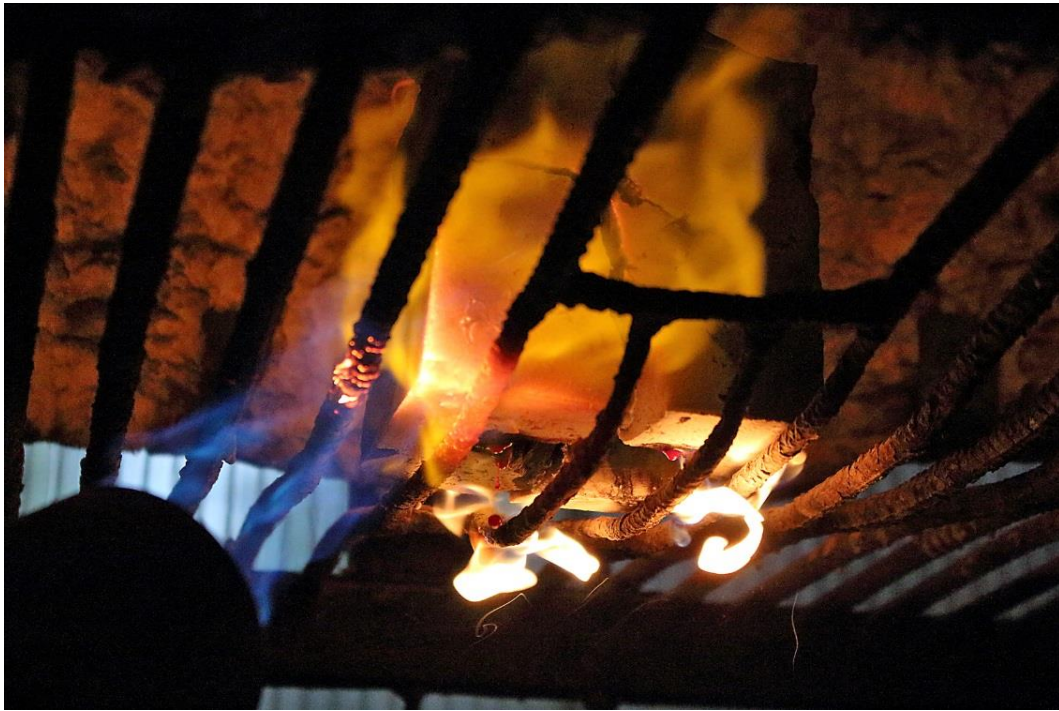
Figura 39: José Javier Ángeles Alejo. (2017) Estudio de la materia: Fases de moldeo con árido algínico . Fotografía digital. Acumulación de temperatura en la superficie del molde. Superficie al rojo vivo.
