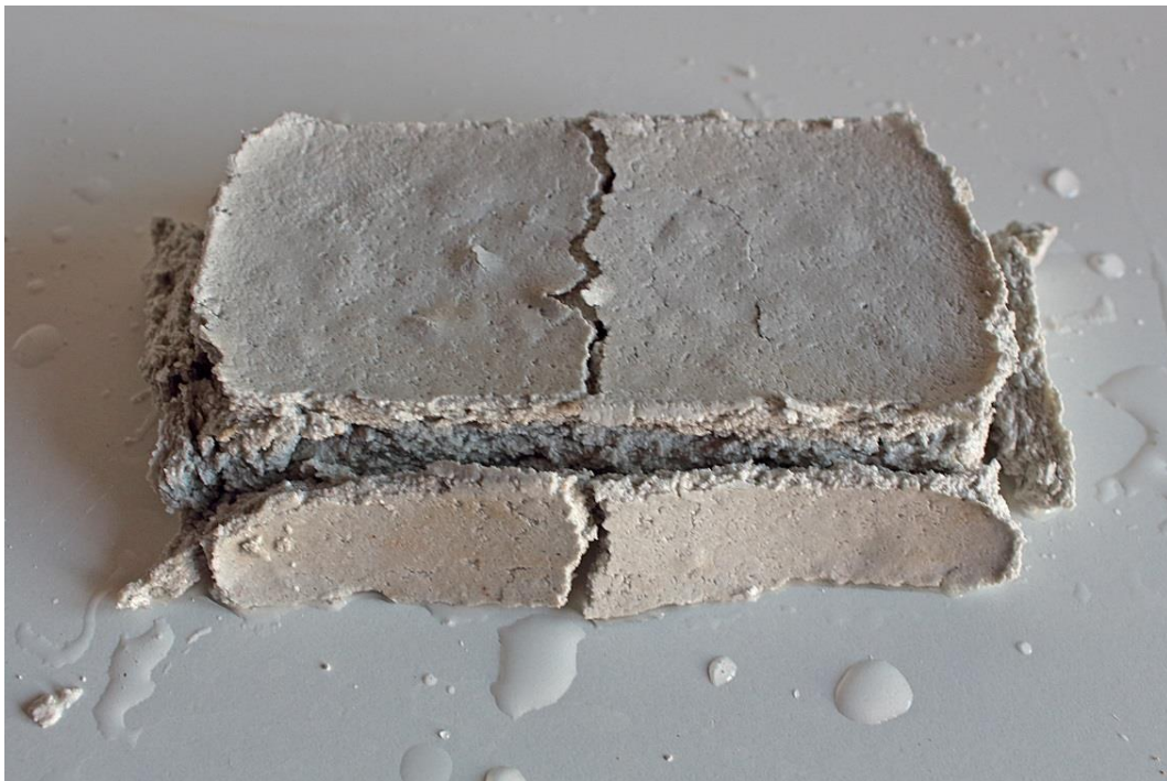
Figura 29: José Javier Ángeles Alejo. (2017) Probeta n°3 . Fotografía digital. Árido algínico reutilizado. Aumento de volumen y separación de fragmentos desprendidos por absorción masiva de agua.
