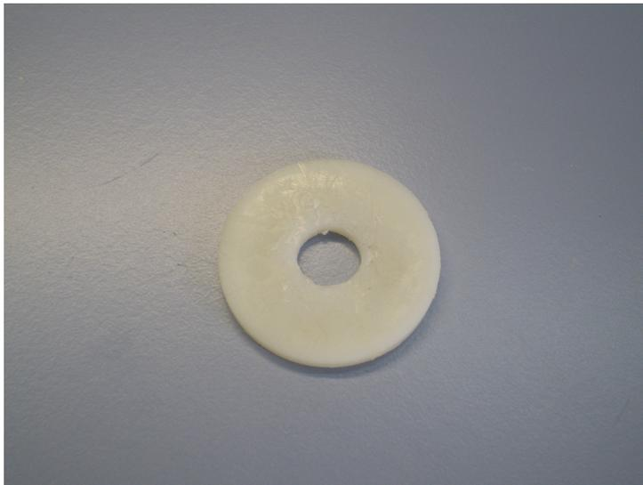
Figura 9. Molde de teflón para preparación de los discos para el test de microdureza.
