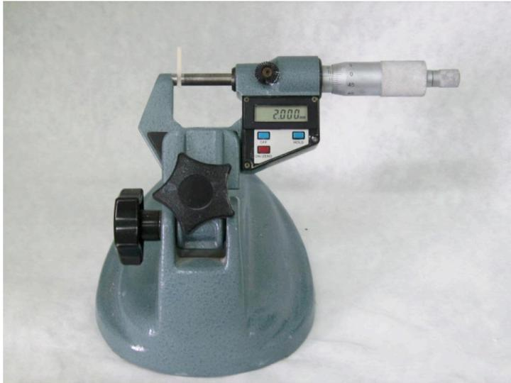
Figura 17. Medidor de espesor para estandarización de las muestras.
