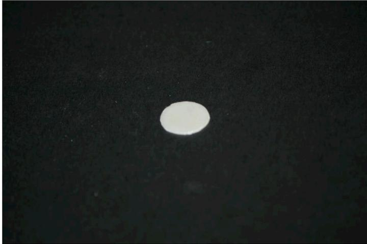
Figura 6. Disco de resina compuesta para los tests de sorción y solubilidad.
