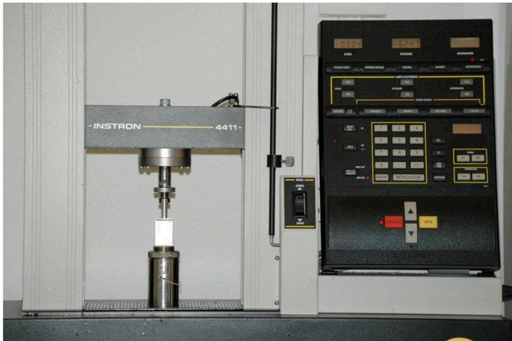
Figura 18. Máquina de ensayo universal 4411 Instron (Instron, Germany).
