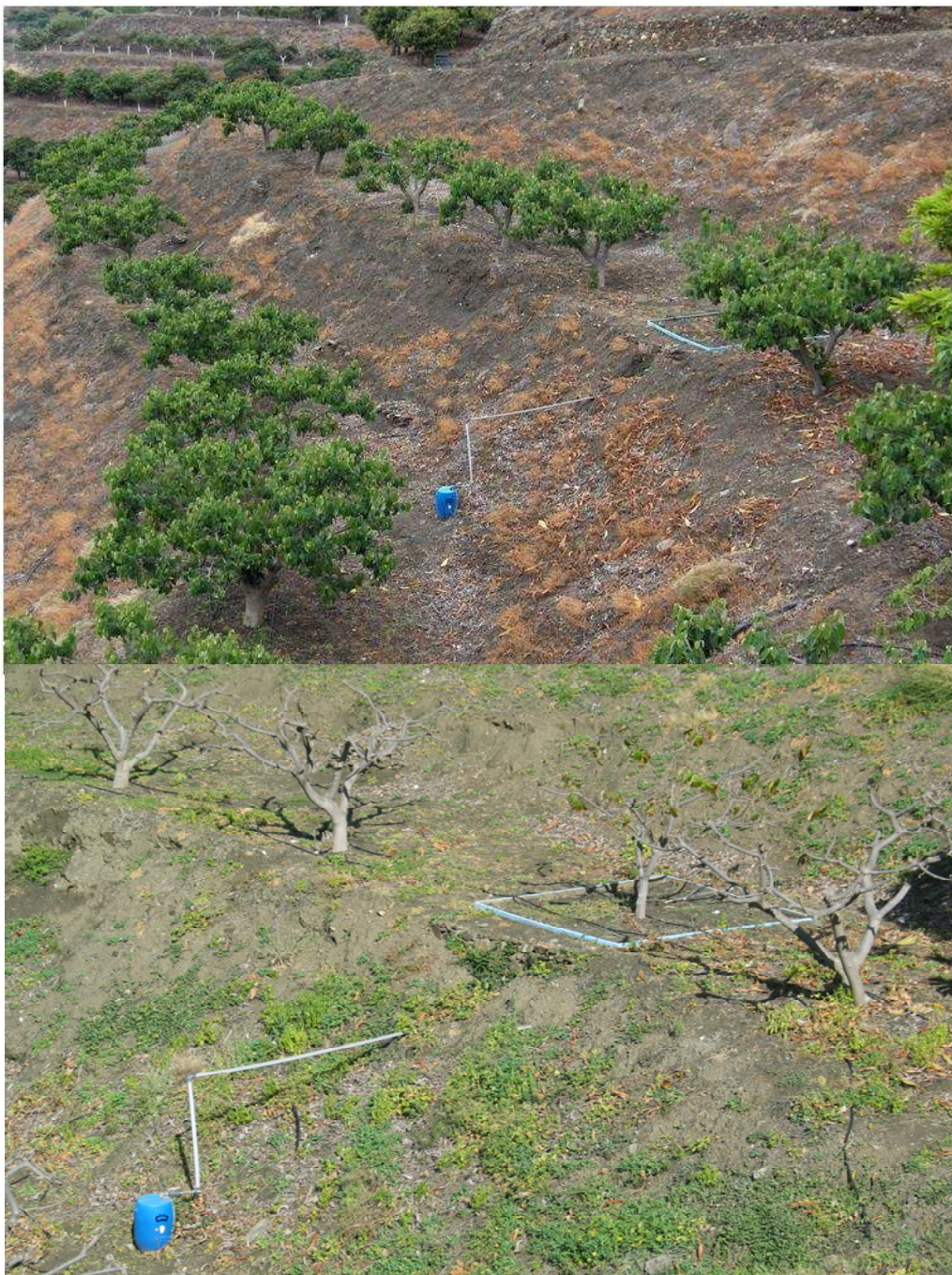
Foto 4. Lisímetro de drenaje en chirimoyo
