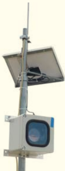
a) Cámara de seguimiento de la nieve en el valle del río Trevélez, b) dos imágenes de dos fechas distintas restituídas y georreferenciadas.
