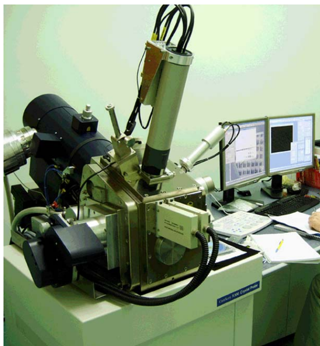
Figure 3-2. CamScan X5000FE CrystalProbe installed at “Service commun de microscopie électronique et analytique” l’Université Montpellier 2. Picture courtesy of David Mainprice.
