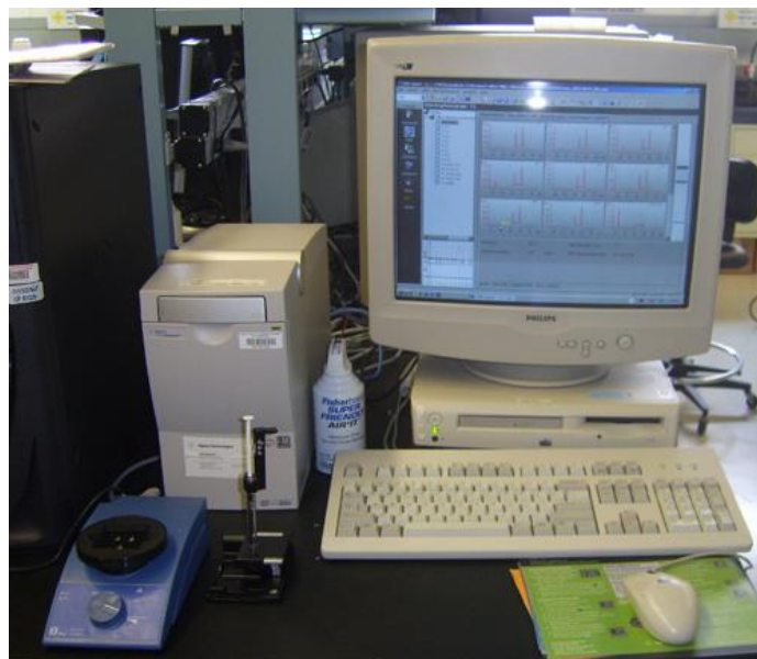
Figura 17. El bioanalizador Agilent tiene capacidad para evaluar la calidad del ARN desde 250 pg del ARN total.
