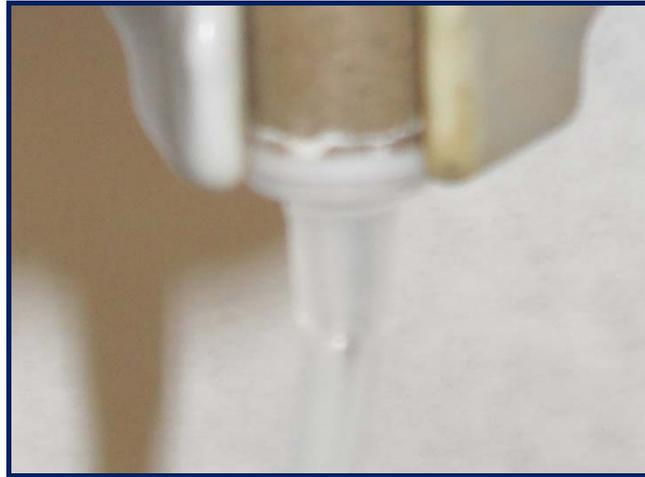
**Figura 8.40-** *Detalle de la acumulación de jabón cálcico precipitado en la cabeza de la columna.*
