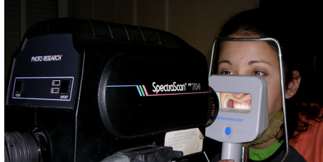
Figura III.9. Toma de color con el espectrorradiómetro SpectraScan PR-704® y la lámpara Shade Light®.
