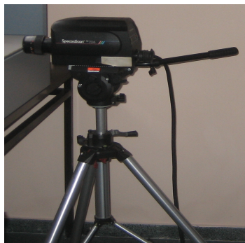
Figuras III.4. y III.5. Espectrorradiómetro SpectraScan PR-704/PC® de Photo Research y esquema de sus componentes, respectivamente.
