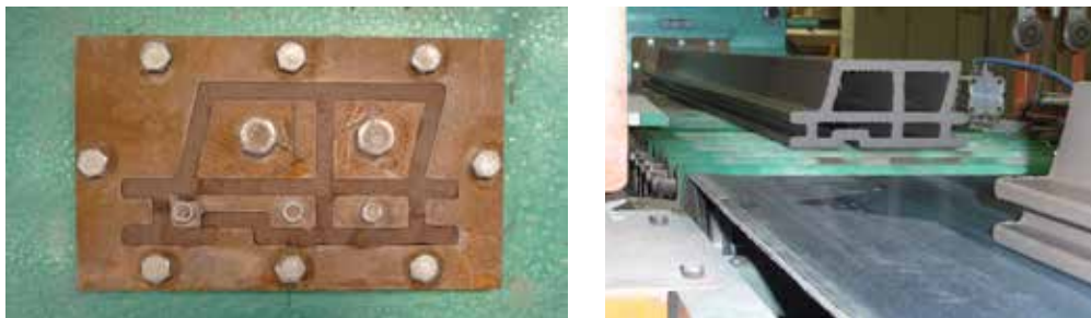
MATRIZ DE FABRICACIÓN DEL MOLDE CERÁMICO DE LAS PIEZAS DE FACHADA DE LA ESCUELA DE MAGISTERIO Y VISTA DE LAS PIEZAS ESTRUSIONADAS EN LA FÁBRICA.
