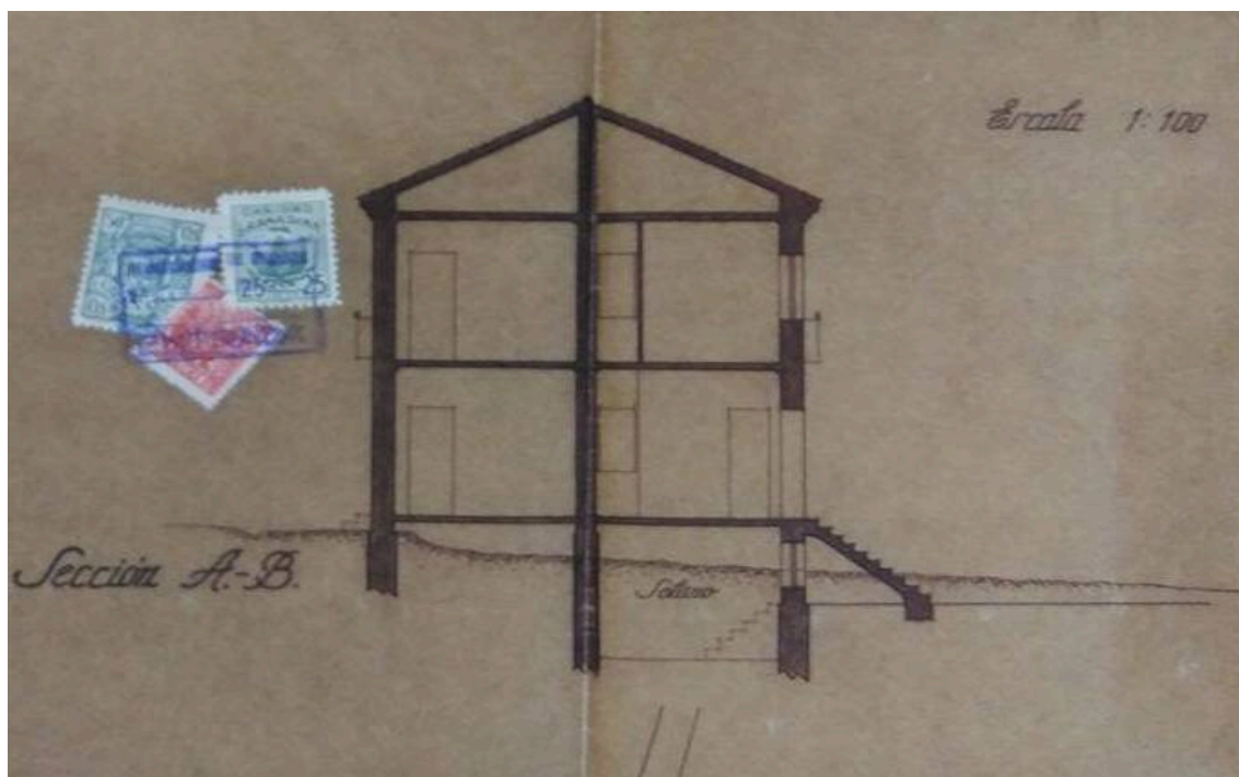
Francisco Prieto-Moreno. Detalle de la Sección, donde destaca la adaptación de los pilares de los cimientos al terreno, y el parecido de la vivienda a las otras propuestas en este capítulo. Construir un edificio en el Camino de Alfacar . AMGR, signatura, C.03078.515 (1943),
