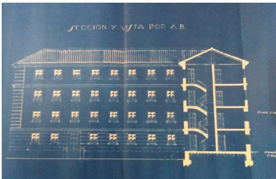
Miguel Olmedo. Detalle de las secciones A y B del edificio, haciendo hincapié en la esquina donde confluyen dos brazos del edificio. Observamos la división por plantas, los tramos de escalera y la disposición de muros y ventanas. Nuevas Eras de Cristo, construcción de 32 viviendas . AMGR, signatura, C.03152.0832 (1951).
