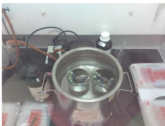
*Figura 48. Disposición de las armaduras galvanizadas extraídas del hormigón durante el baño en ácido con ultrasonidos para la limpieza de sus productos de corrosión y restos de hormigón*
