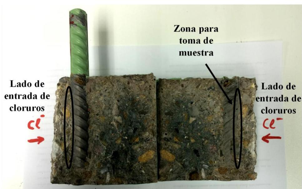
Figura 47. Detalle de toma de muestras de hormigón en una probeta del ensayo de corrosión de armaduras inducida por penetración de cloruros
