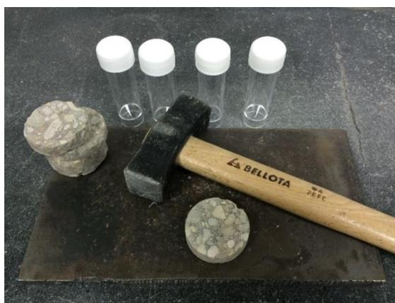
*Figura 42. Rodajas de hormigón, extraídas del testigo cilíndrico, antes de su trituración y molido previos al análisis del contenido de cloruros*
