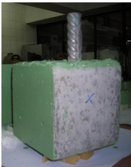
*Figura 45. Probeta tipo para el ensayo de corrosión inducida por penetración de cloruros*
