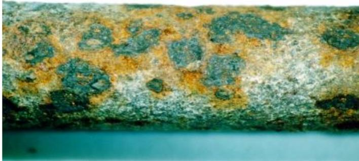
Figura 9. Armadura en un estado avanzado de corrosión por ataques locales
