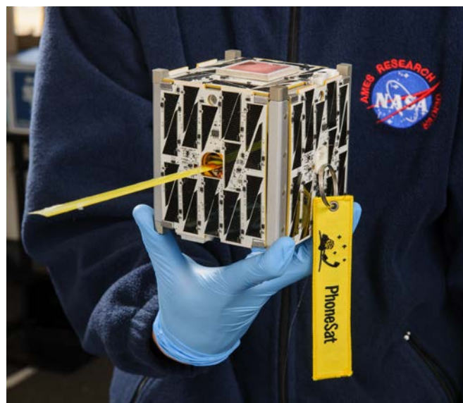
Figura 1.1 Cubesat 1U. Fuente: https://www.nasa.gov
